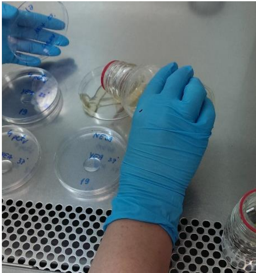
Slika 8. Pour plate metoda analize vode
