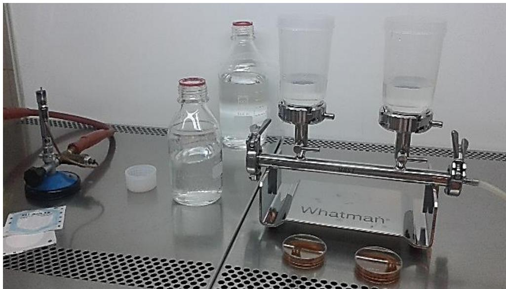
Slika 9. Sistem za membransku filtraciju
