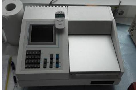
**Slika 9.** Spektrofotometar
