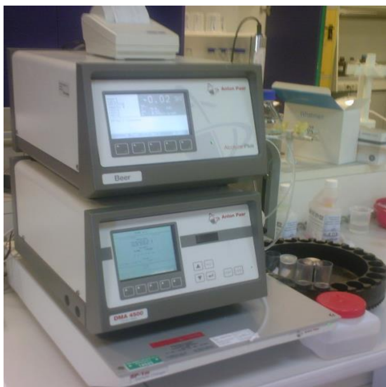
Slika 10. Alcolyzer Plus Beer – instrument za određivanje alkohola. Izvor: vlastita fotografija
