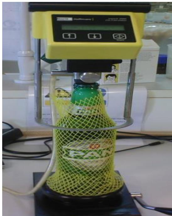
Slika 8. Uredaj za određivanje CO<sub>2</sub> u pivu. Izvor: vlastita fotografija
