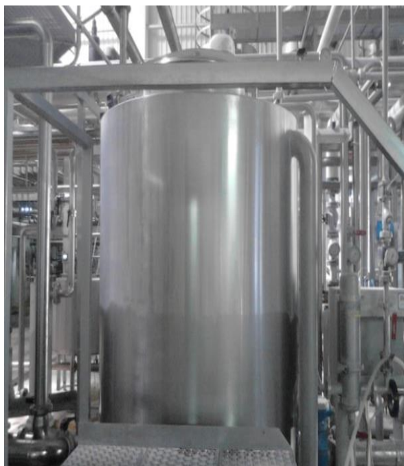
Slika 4. Posuda za usip dijatomejske zemlje. Izvor: vlastita fotografija
