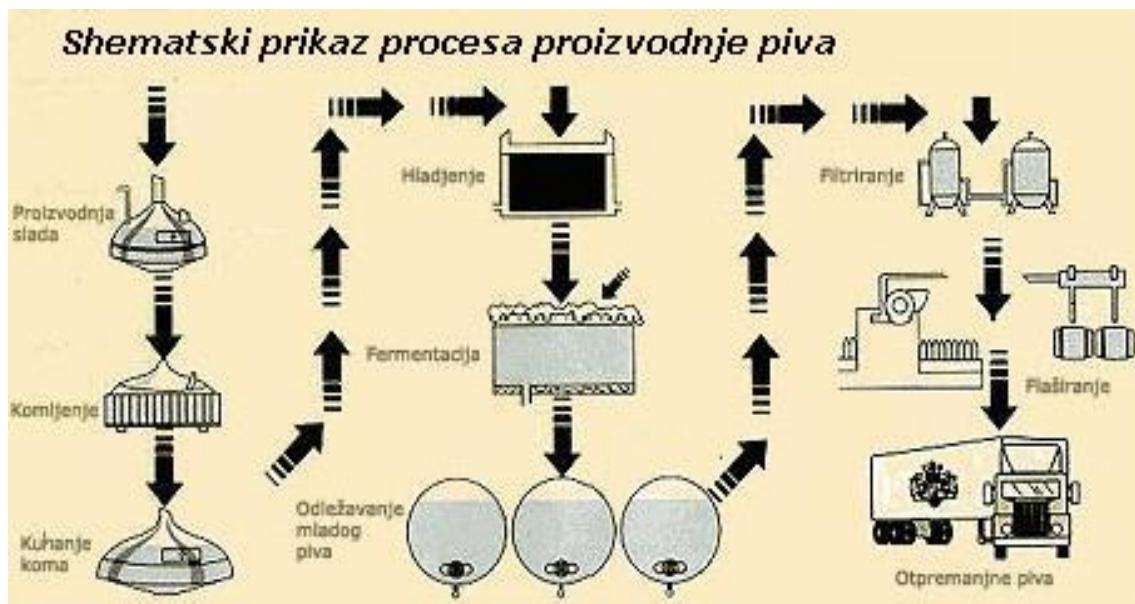
Slika 1. Shema proizvodnje piva. Izvor: [http://www.pinta.hr/o\\_pivu/izrada\\_piva.html](http://www.pinta.hr/o_pivu/izrada_piva.html)
