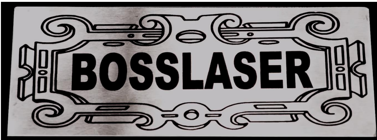
Slika 39. Konačan izgled pločice nakon laserskog markiranja
