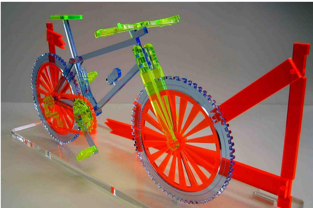
Slika 13. Model bicikla izrađen laserskom obradom
