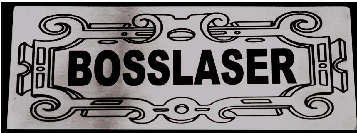
Slika 39. Konačan izgled pločice nakon laserskog markiranja
