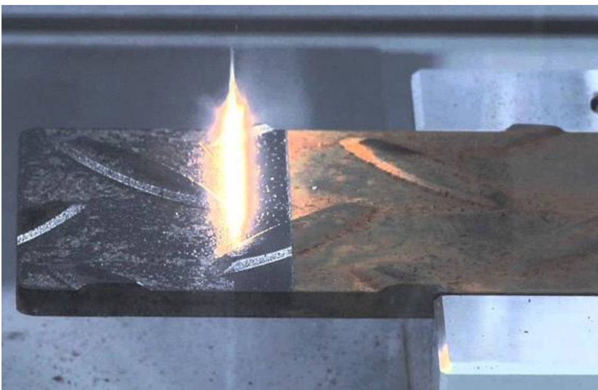
Slika 25. Lasersko skidanje korozije s metala
