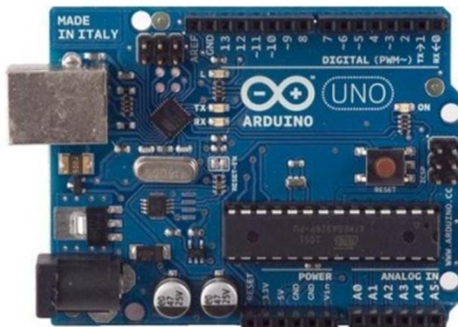
Slika 1. Predodžba Arduino Uno ATmega328 mikrokontroler ploče
