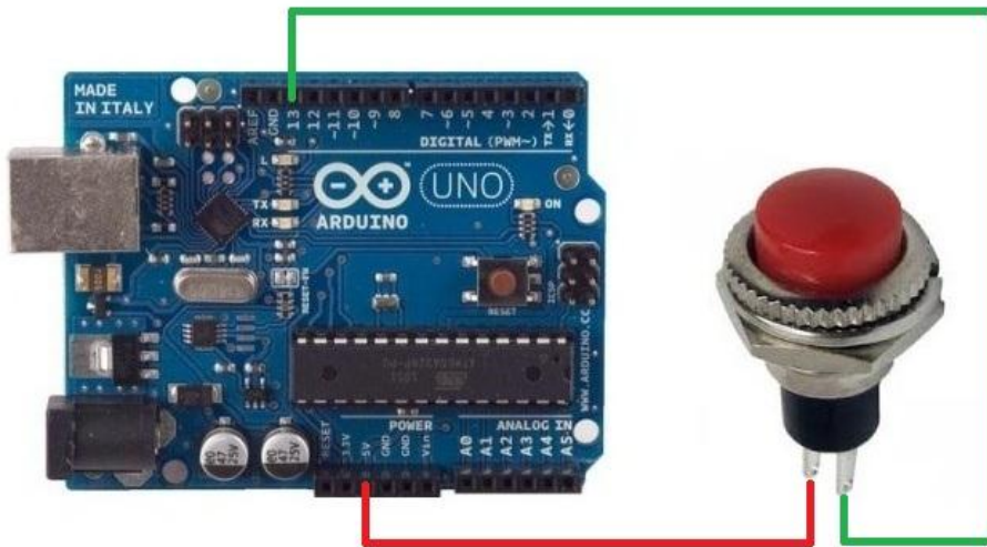
Slika 16. Predodžba spajanja tipkala
