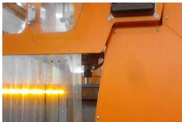
Slika 5. Umjeravanje alata
