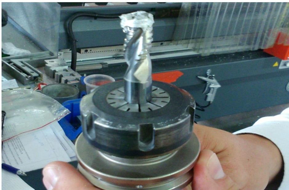
Slika 16. Lijepljenje odvojene čestice za alat
