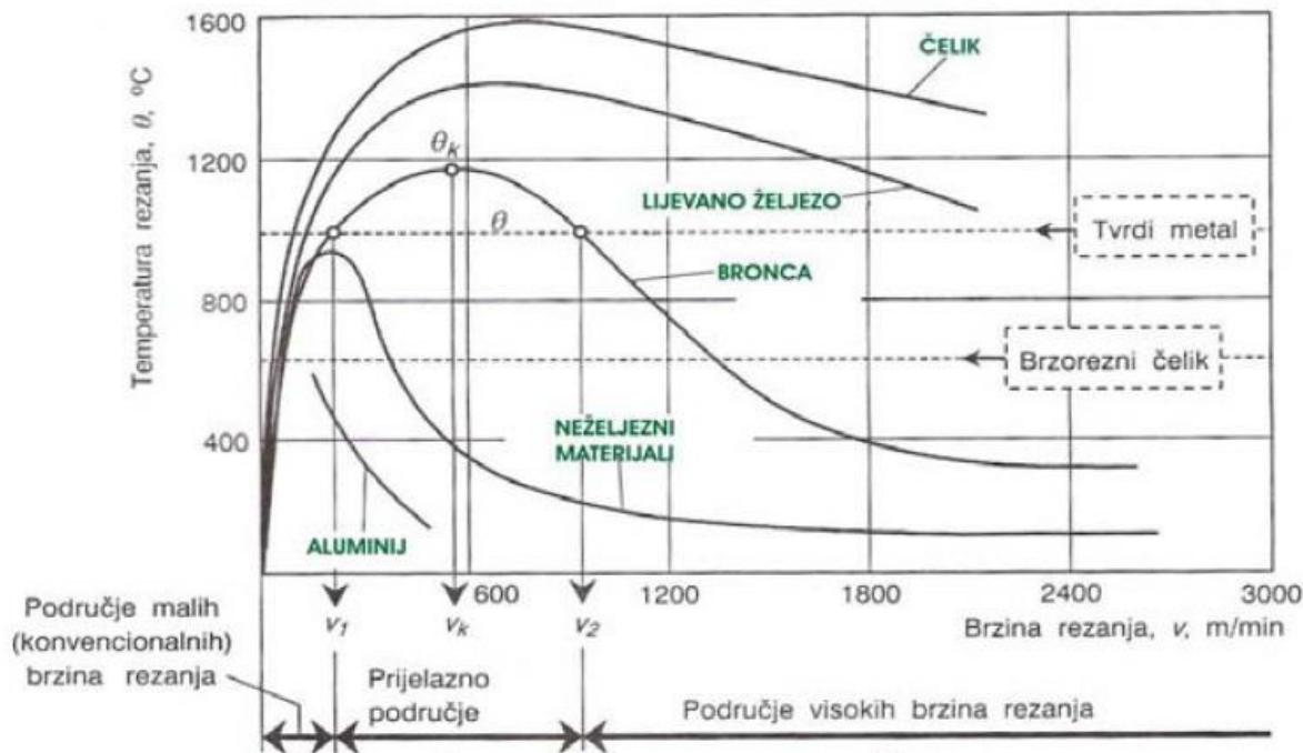
Slika 15. Ovisnost temperature i brzine rezanja [9]
