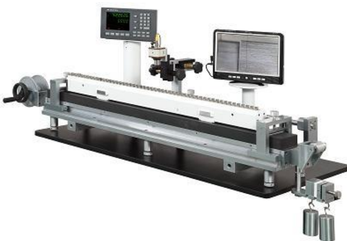
Slika 38. Uređaj za umjeravanje mjernih traka
