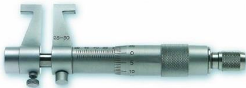
Slika 26. Mikrometar za unutarnja mjerenja [21]
