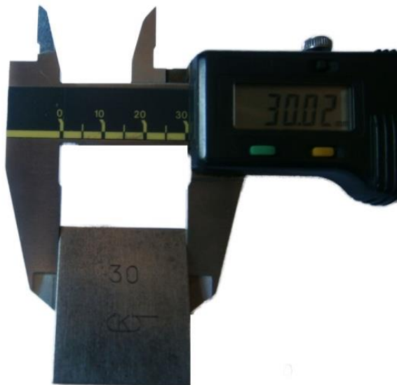
Slika 43. Drugo mjerenje etalona od 30 mm
