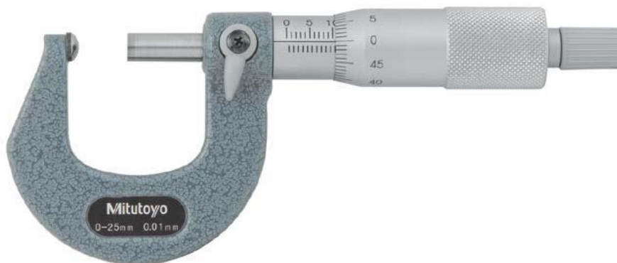
Slika 25. Mikrometar za mjerenja debljine stjenke
