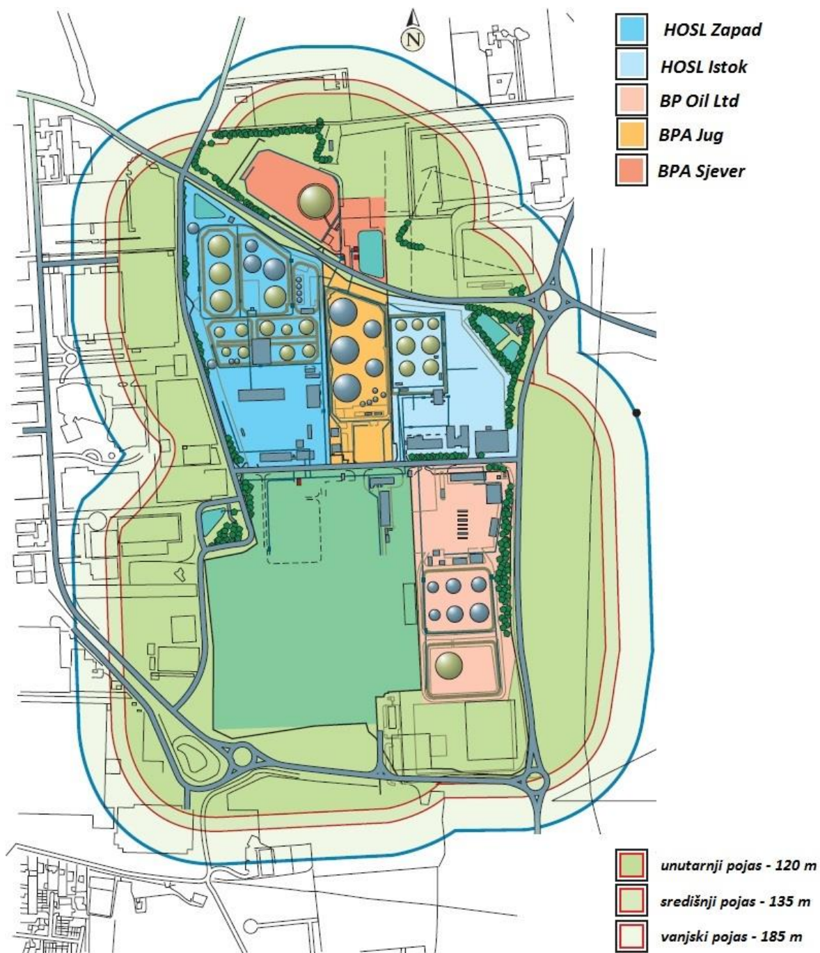
Slika 19: Tlocrt naftnog terminala „Buncefield“ - sekcije i zaštitni pojasevi [7].
