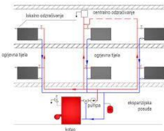
Slika 10: Jednocijevni sustav sa serijskim spajanjem radijatora
