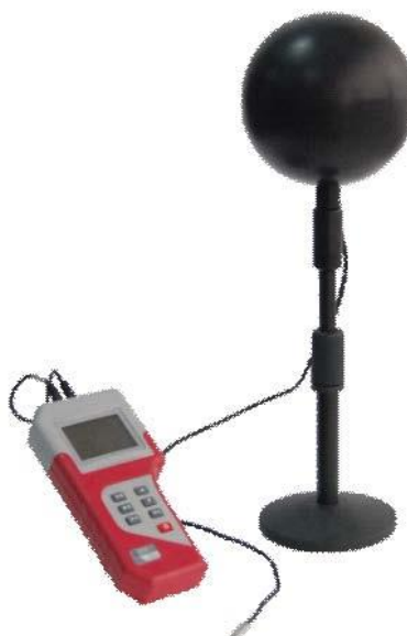
Slika 2. Predodžba globus termometra
