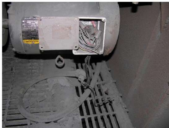
Slika 14. Motor i izložene žice [14].
