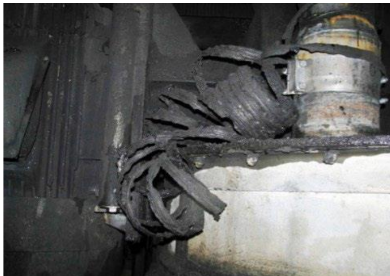
Slika 18. Spiralna ovojnica za koju su radnici izjavili da se topi i kaplje [15].
