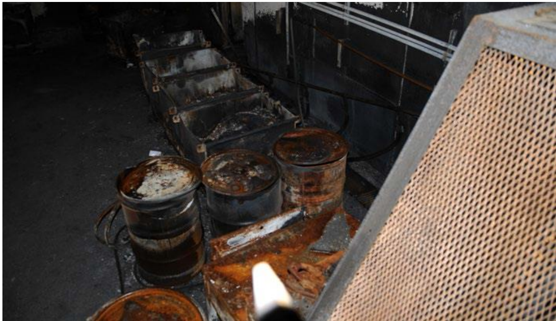
Slika 7. Otvorene bačve titana i cirkonija u proizvodnoj zgradi [11].
