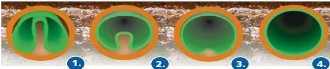
SI. 6. Ugradnja nove cijevi [3]
