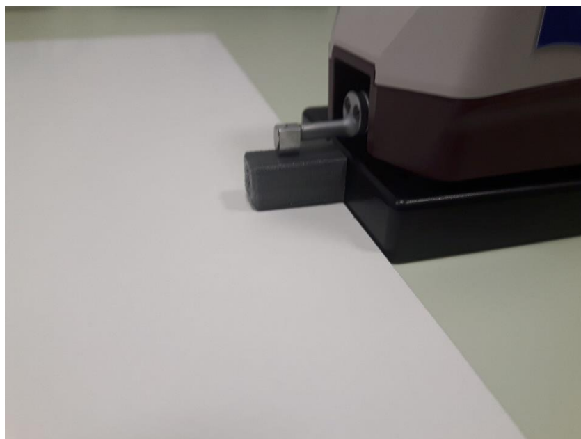
Slika 31. Mjerenje hrapavosti epruvete.
