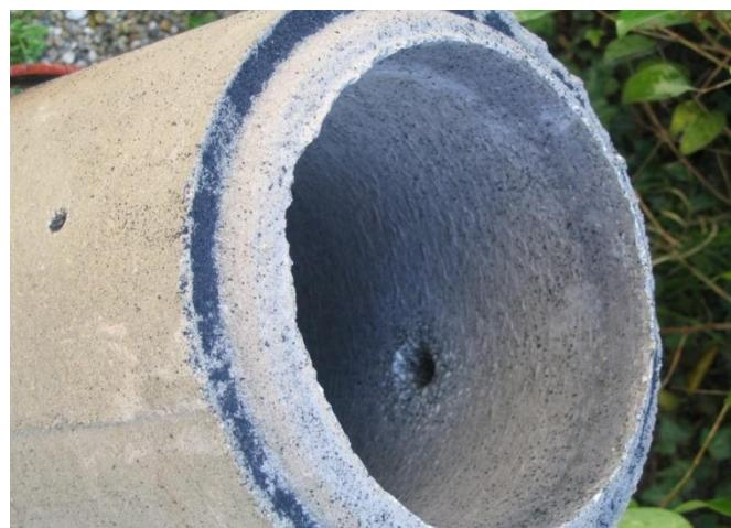
Sl.28. Primjer probijanja betona sustavom "Cobra" [20]
