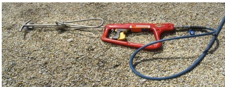
Sl.26. Mlaznica "Cobra" sustava [20]
