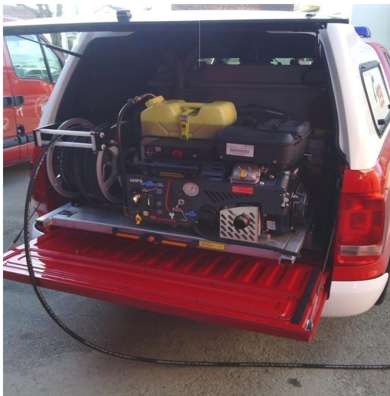
Sl.25. Visokotlačni sklop malog navalnog vozila [14]
