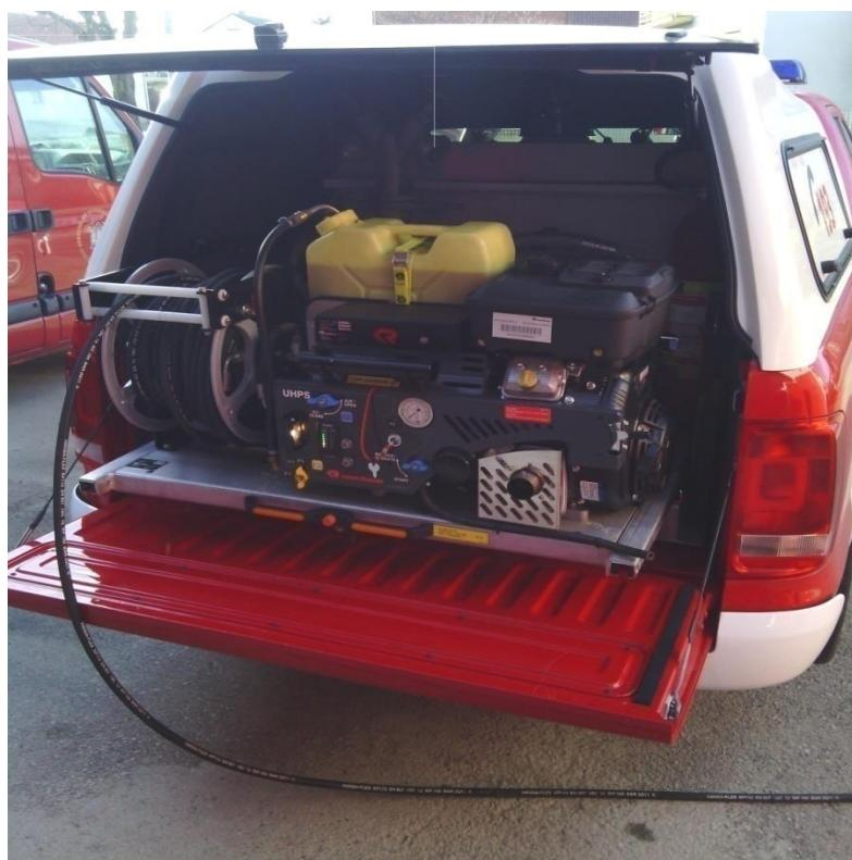
Sl.25. Visokotlačni sklop malog navalnog vozila [14]
