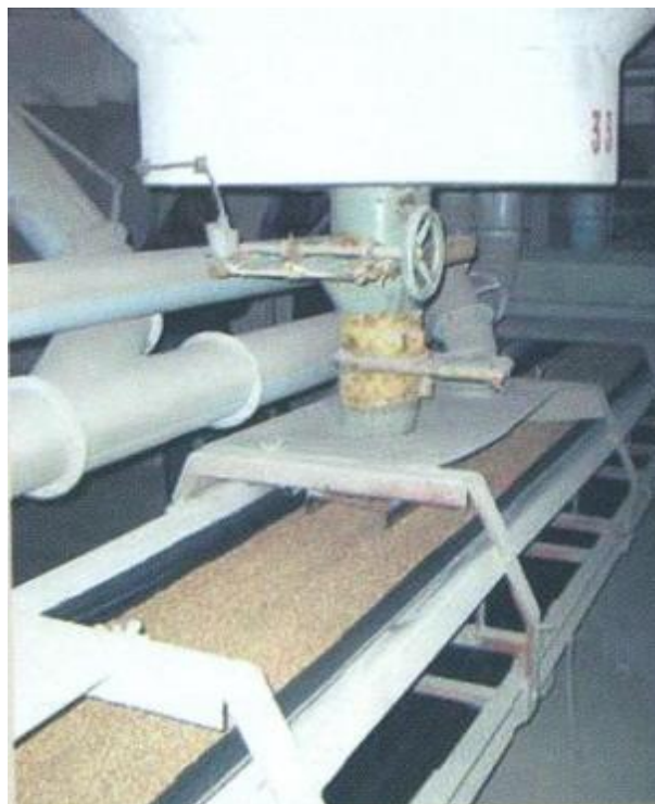
Sl.10. Transportna traka u podu silosa [10]
