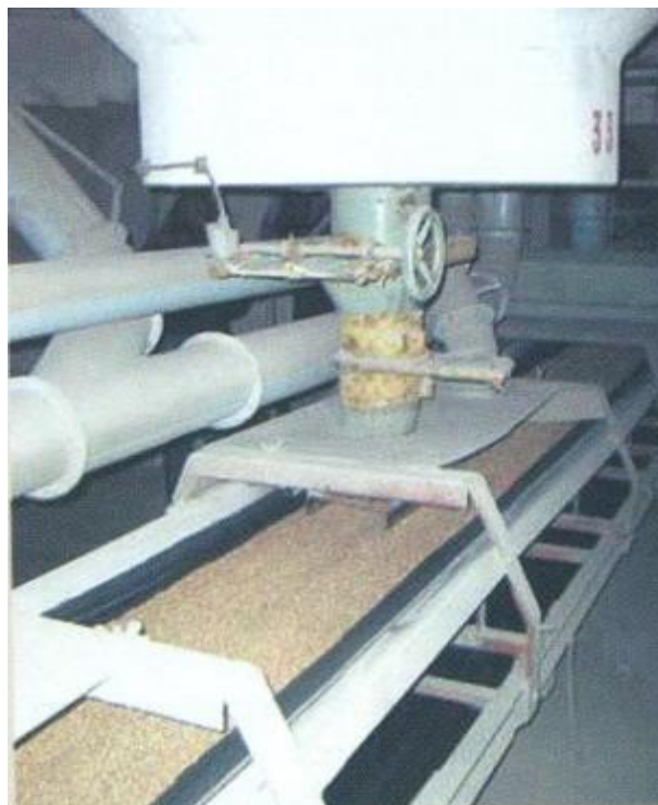
Sl.10. Transportna traka u podu silosa [10]
