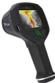
Sl.16. Termo-kamera za vatrogasce [16]
