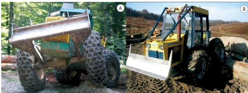
Slika 4. Poprečno prilagođavanje skidera terenu/preprekama (izvor: http://hrcak.srce.hr/161587/ 2016.)
