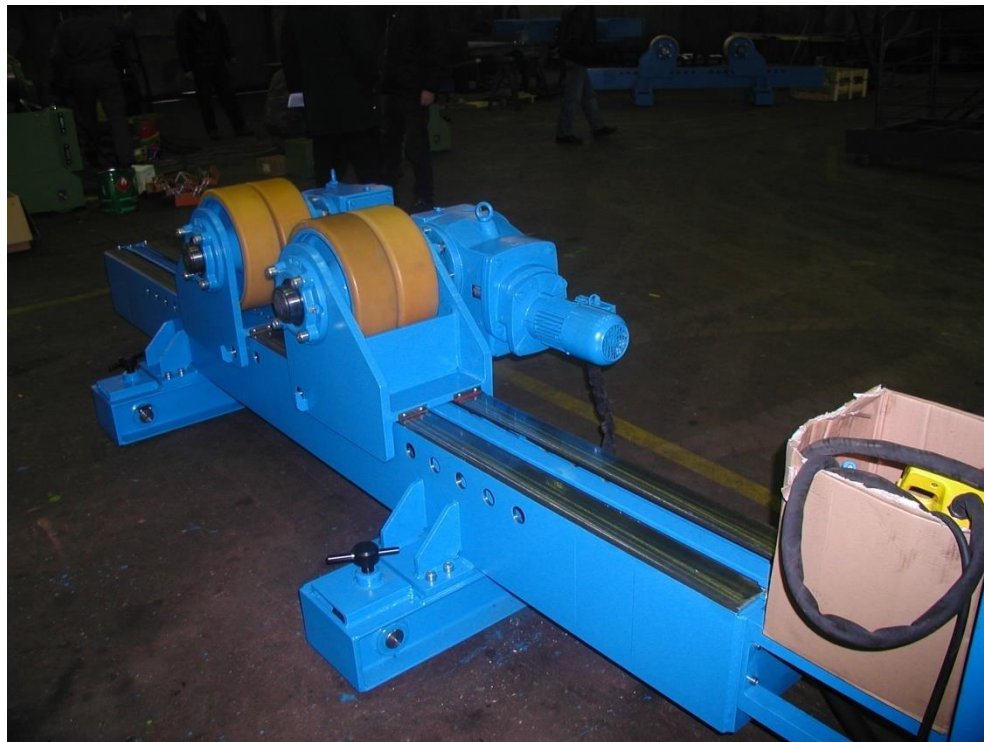
Slika 1.1. Pogonska jedinica 30 t okretaljke, vulkolanski kotači
