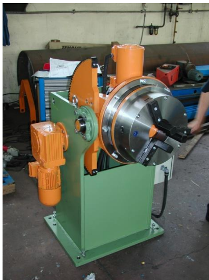
Slika 1.8. Pozicioner UM-DT500 s tročeljusnom steznom glavom
