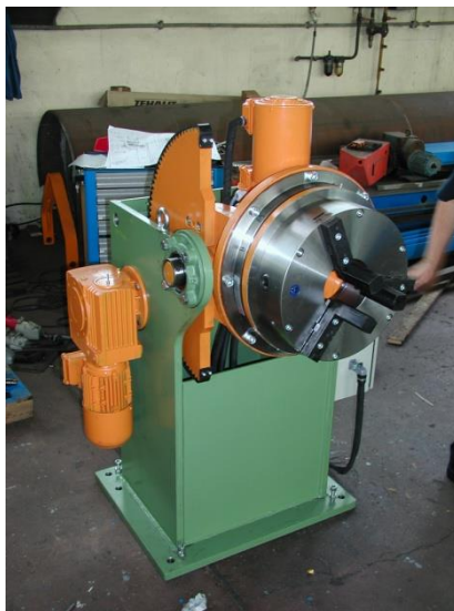
Slika 1.8. Pozicioner UM-DT500 s tročeljusnom steznom glavom
