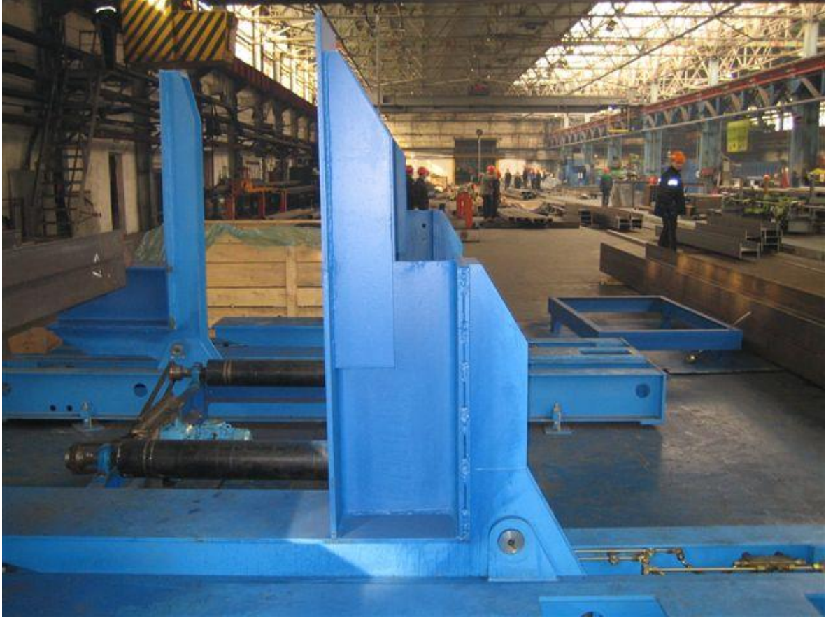
Slika 1.33. Uređaj za preokretanje profila na radne stolove
