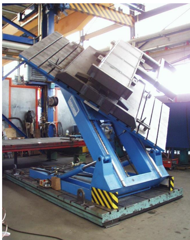
Slika 1.9. Pozicioner za montažu i zavarivanje 3 t
