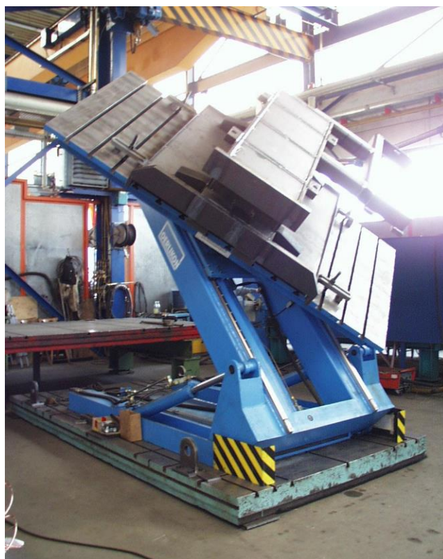
Slika 1.9. Pozicioner za montažu i zavarivanje 3 t
