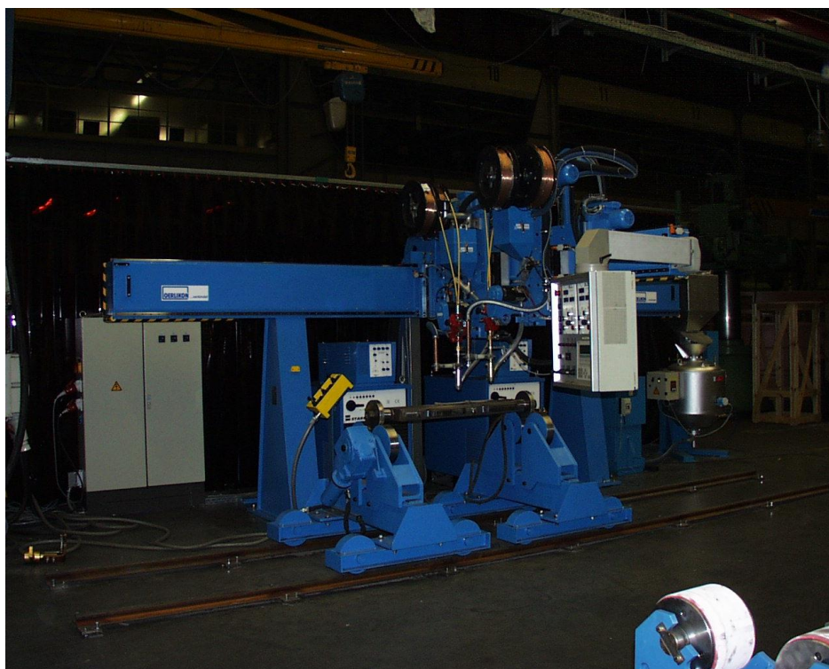
Slika 1.17. „Uzdužni“ nosač automata s EPP opremom za zavarivanje osovine
