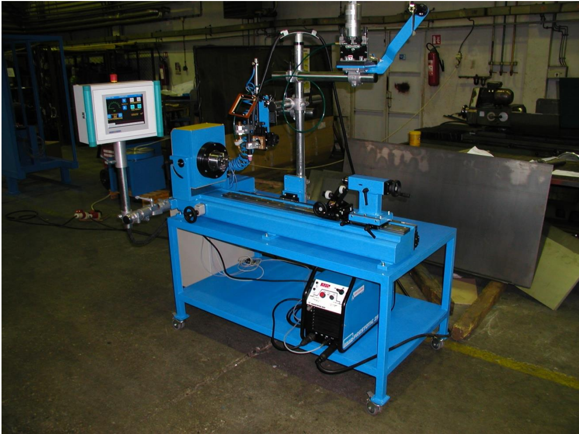
Slika 1.24. CITOTURN-UNITURN uređaj za zavarivanje, TIG+dodavanje žice
