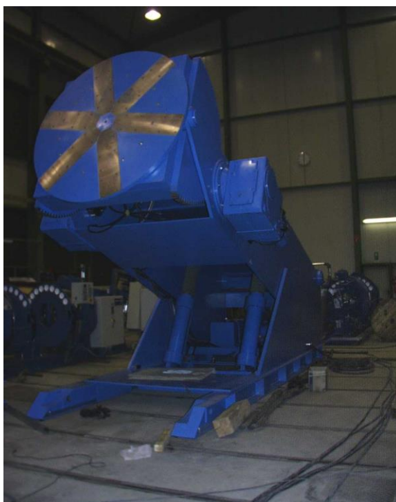
Slika 1.6. Pozicioner POSISAF 26F, elektromotorna os okretanja, dvije hidrauličke osi
