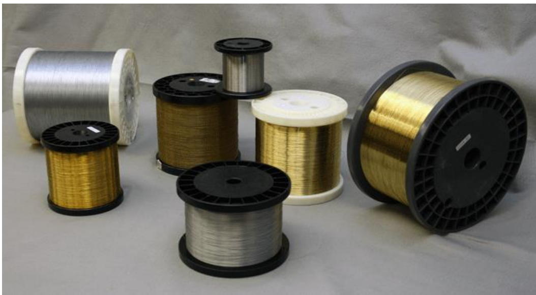
Slika 11. Žica za edm rezanje, [24]
