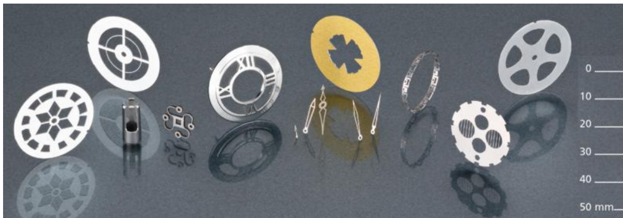
Slika 2. Primjer izradaka nastalih obradom rezanja laserom, [8]
