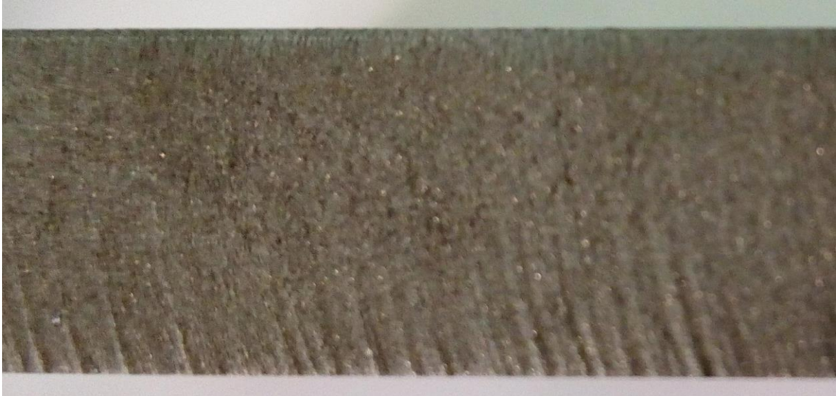
Slika 28. Prikaz bočne površine obratka nakon rezanja abrazivnim vodenim mlazom
