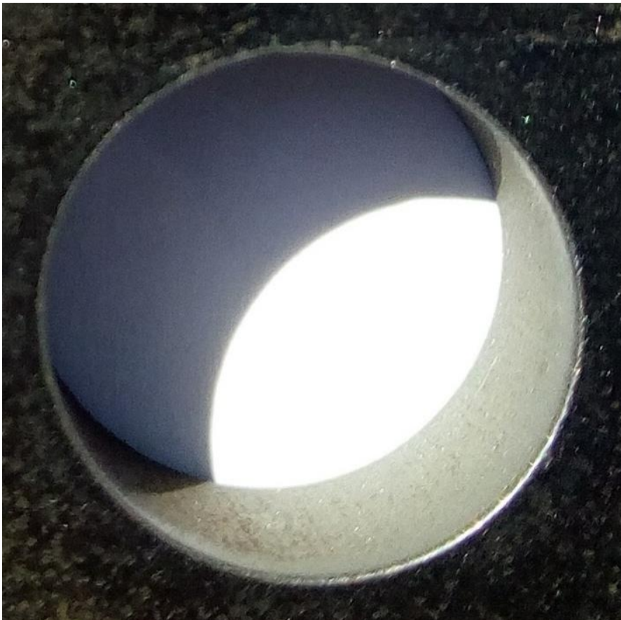
Slika 29. Prikaz površine provrta dobivenog rezanjem abrazivnim vodenim mlazom
