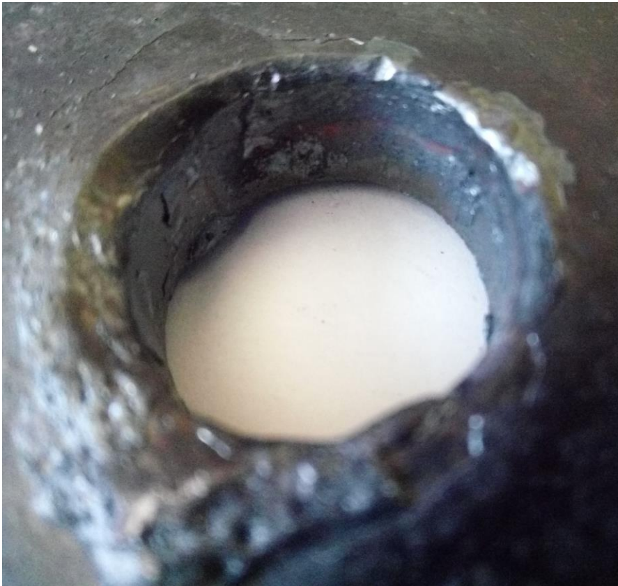
Slika 26. Prikaz površine provrta dobivenog rezanjem plazmom
