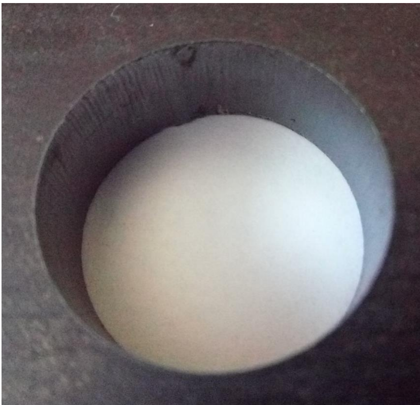
Slika 22. Prikaz površine provrta dobivenog laserskim rezanjem
