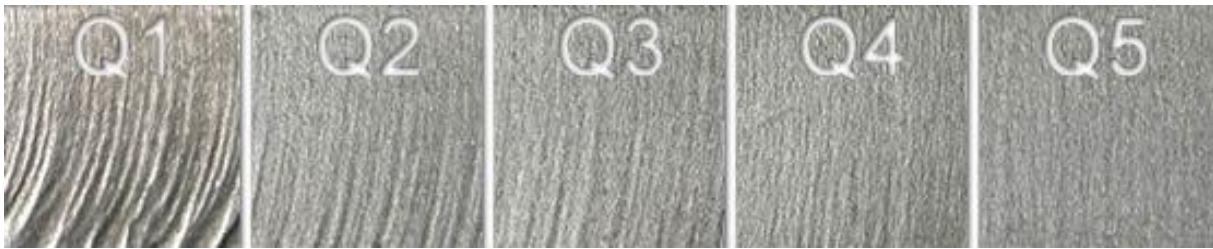
Slika 9. Kvaliteta rezne površine, [20]
