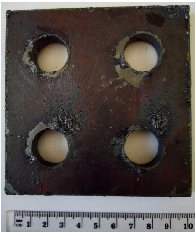
Slika 24. Obradak nakon obrade plazmom, donja površina
