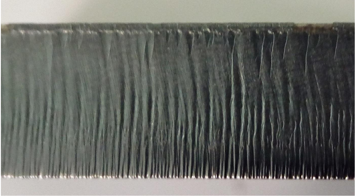
Slika 21. Prikaz bočne površine obratka nakon laserskog rezanja
