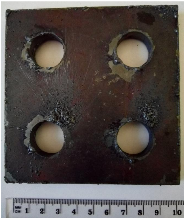
Slika 24. Obradak nakon obrade plazmom, donja površina
