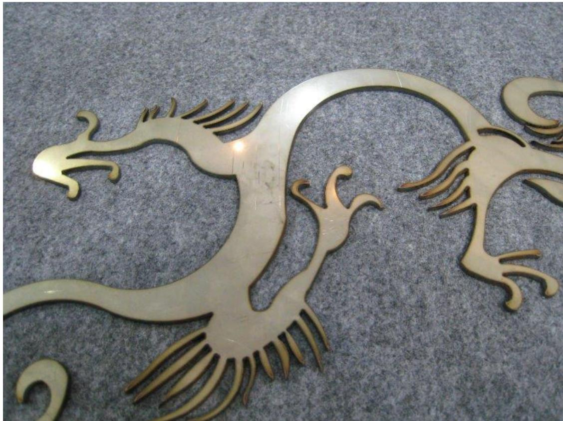
**Slika 5.** Primjer izratka nastalog obradom rezanja plazmom, [14]
