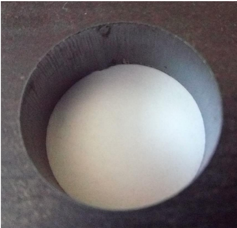
Slika 22. Prikaz površine provrta dobivenog laserskim rezanjem
