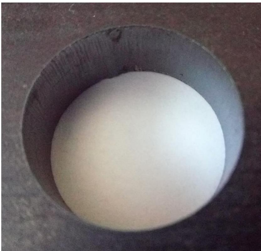
**Slika 22.** Prikaz površine pravrteta dobivenog laserskim rezanjem
