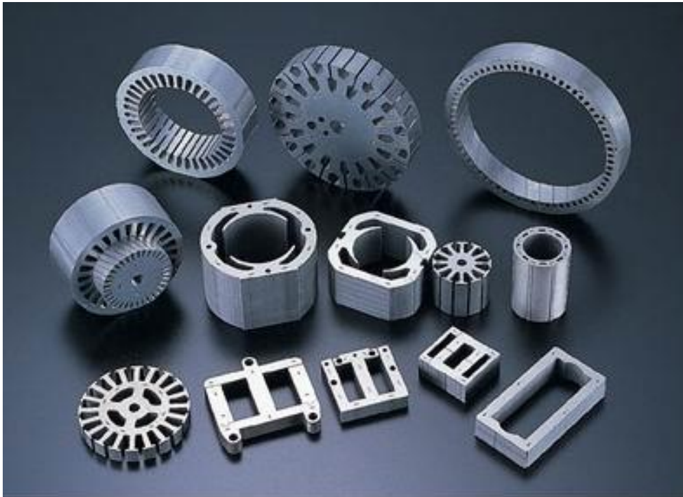
Slika 13. Primjer izradaka nastalih elektroerozijskim rezanjem žicom, [25]
