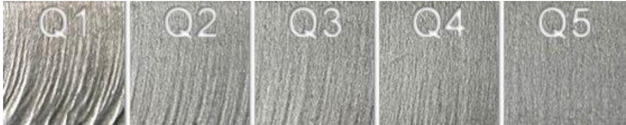
**Slika 9.** Kvaliteta rezne površine, [20]
