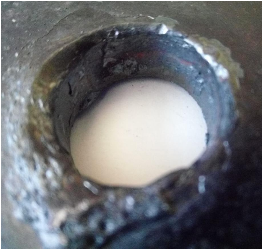
Slika 26. Prikaz površine provrta dobivenog rezanjem plazmom
