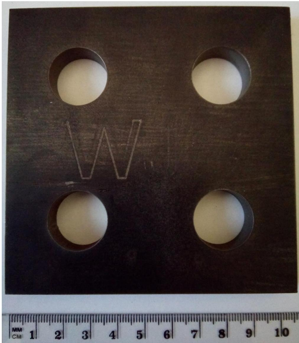
**Slika 27.** Obradak nakon obrade abrazivnim vodenim mlazom
