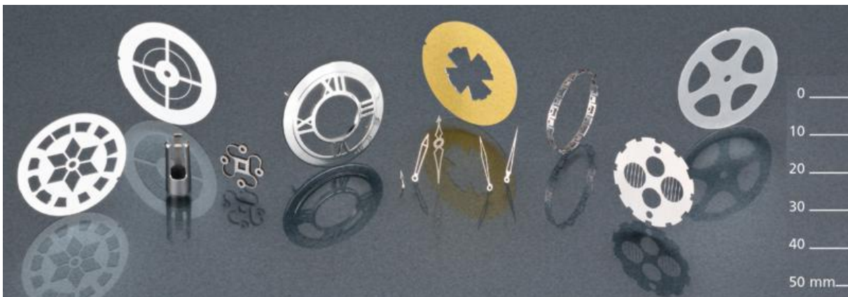
Slika 2. Primjer izradaka nastalih obradom rezanja laserom, [8]
