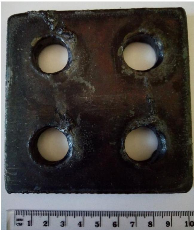
**Slika 23.** Obradak nakon obrade plazmom, gornja površina
