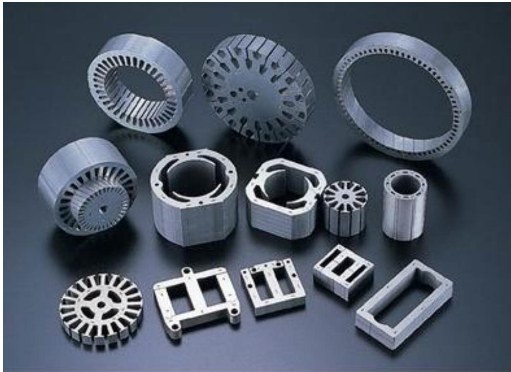
**Slika 13.** Primjer izradaka nastalih elektroerozijskim rezanjem žicom, [25]
