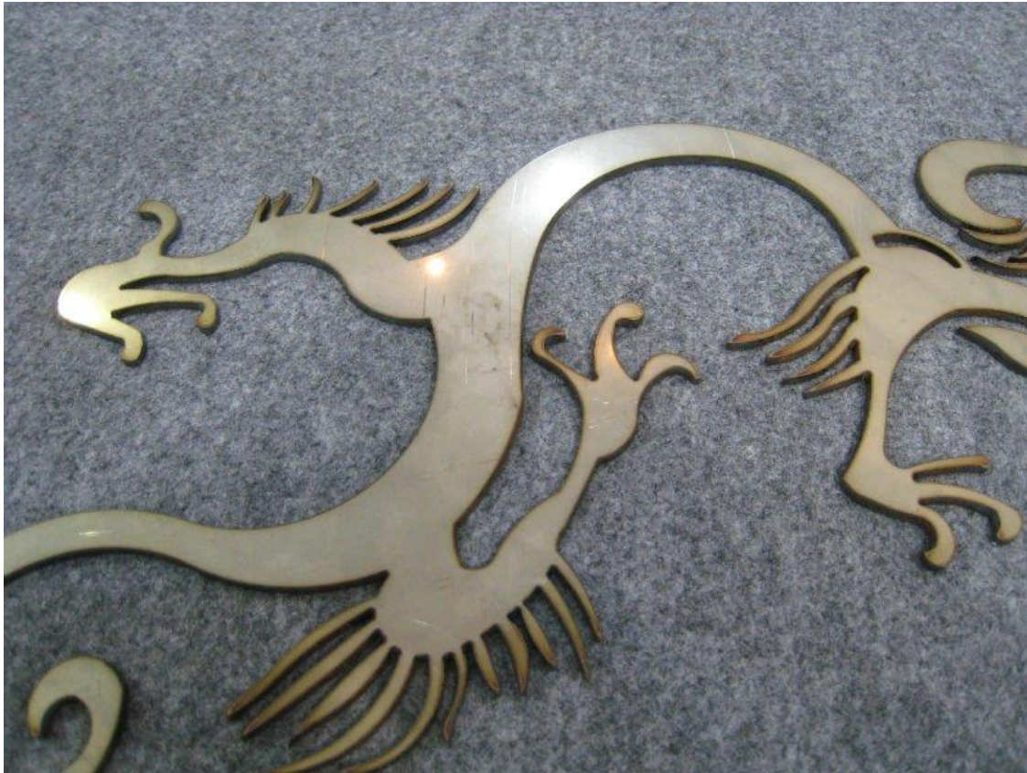
Slika 5. Primjer izratka nastalog obradom rezanja plazmom, [14]
