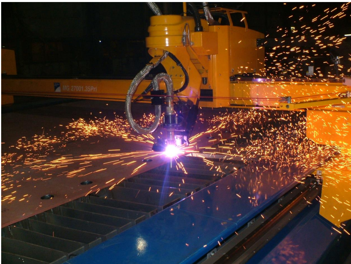
Slika 4. CNC stroj za rezanje plazmom, [13]
