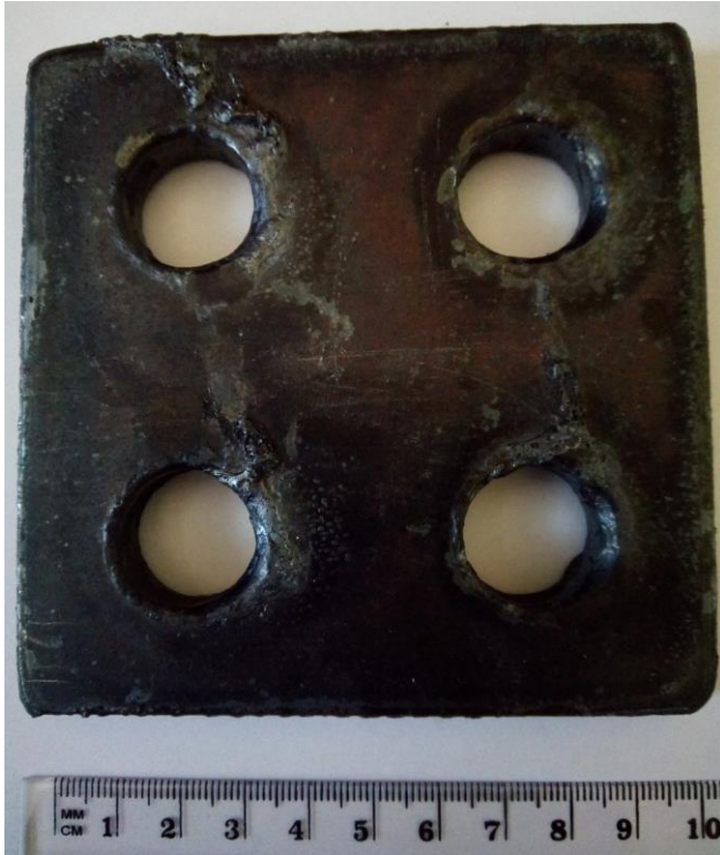
Slika 23. Obradak nakon obrade plazmom, gornja površina
