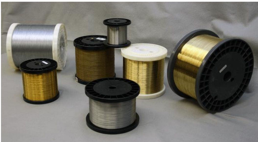
Slika 11. Žica za edm rezanje, [24]
