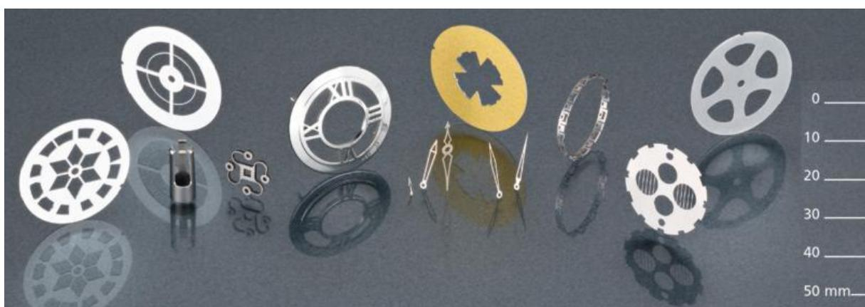
**Slika 2.** Primjer izradaka nastalih obradom rezanja laserom, [8]
