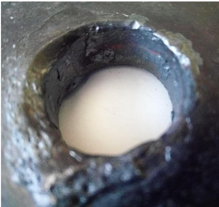
**Slika 26.** Prikaz površine prvorata dobivenog rezanjem plazmom
