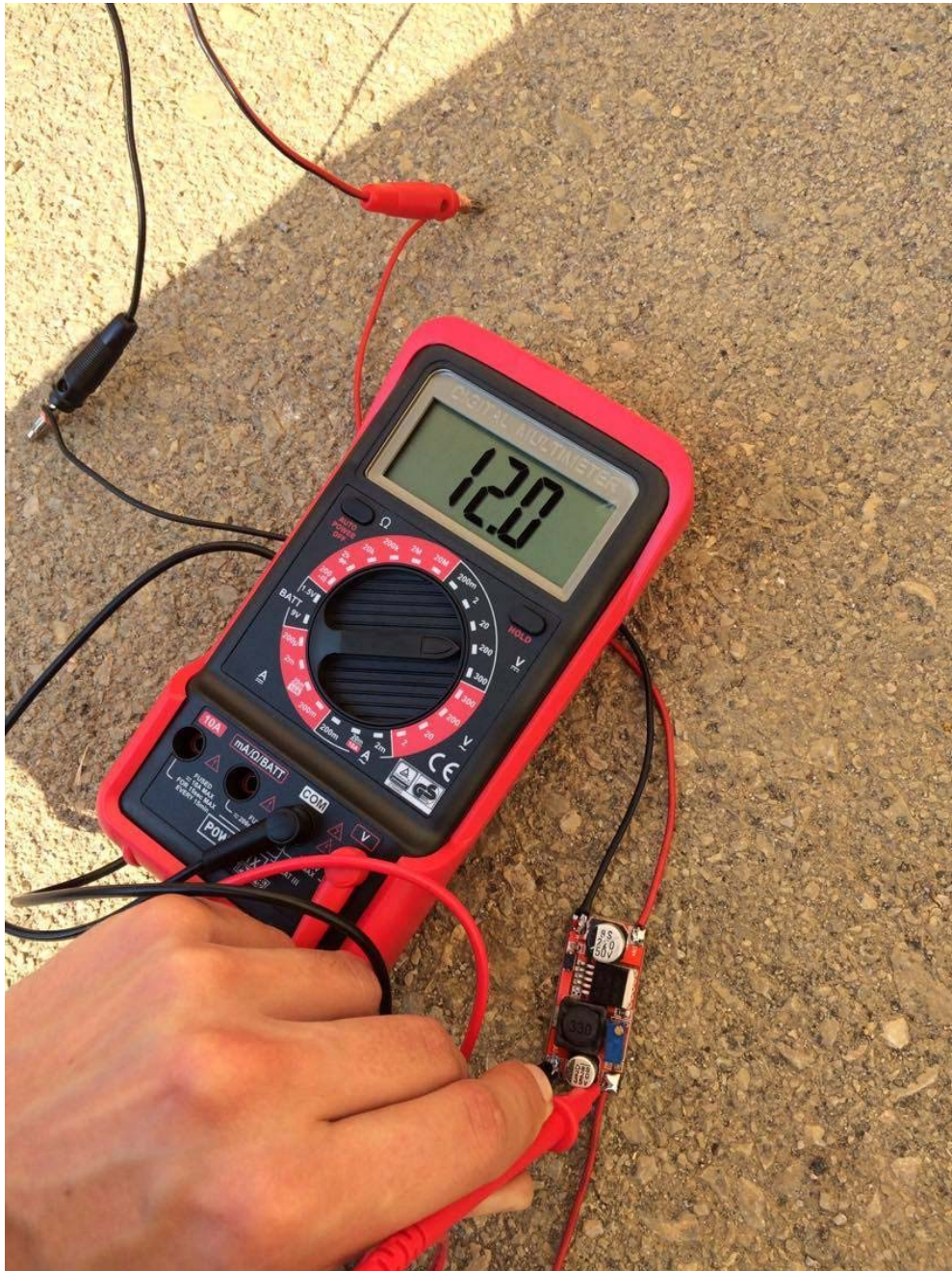
Slika 29. Predodžba mjerenja napona na izlazu DC-DC regulatora
