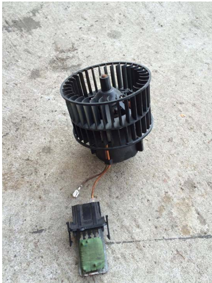
Slika 24. Predodžba otpornika i ventilatora kabine
