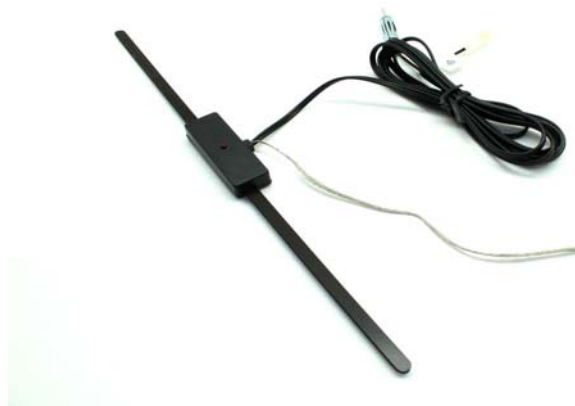
Slika 4. Predodžba unutarnje samoljepljive antene sa pojačalom
