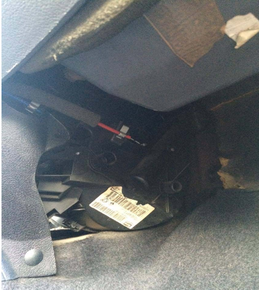
Slika 7. Predodžba mjesta ventilatora kabine ispod kontrolne table
