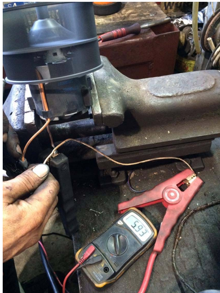
Slika 25. Predodžba mjerenja struje ventilatora
