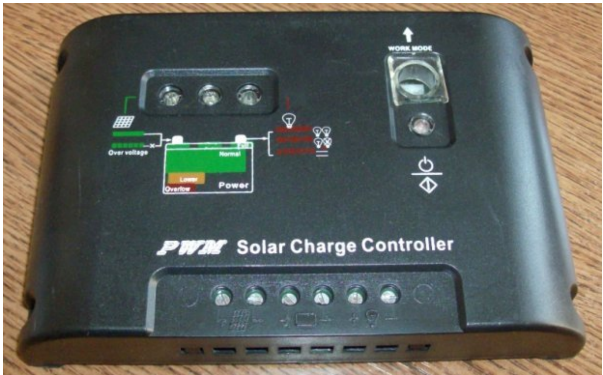
Slika 5. Predodžba solarnog regulatora punjenja
