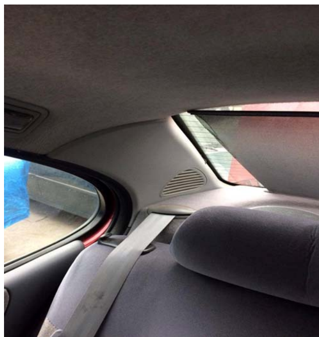
Slika 12. Predodžba zadnjeg desnog „C“ stupa
