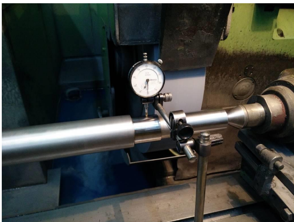
Slika 65. Kontrola radijalnih udara vratila
