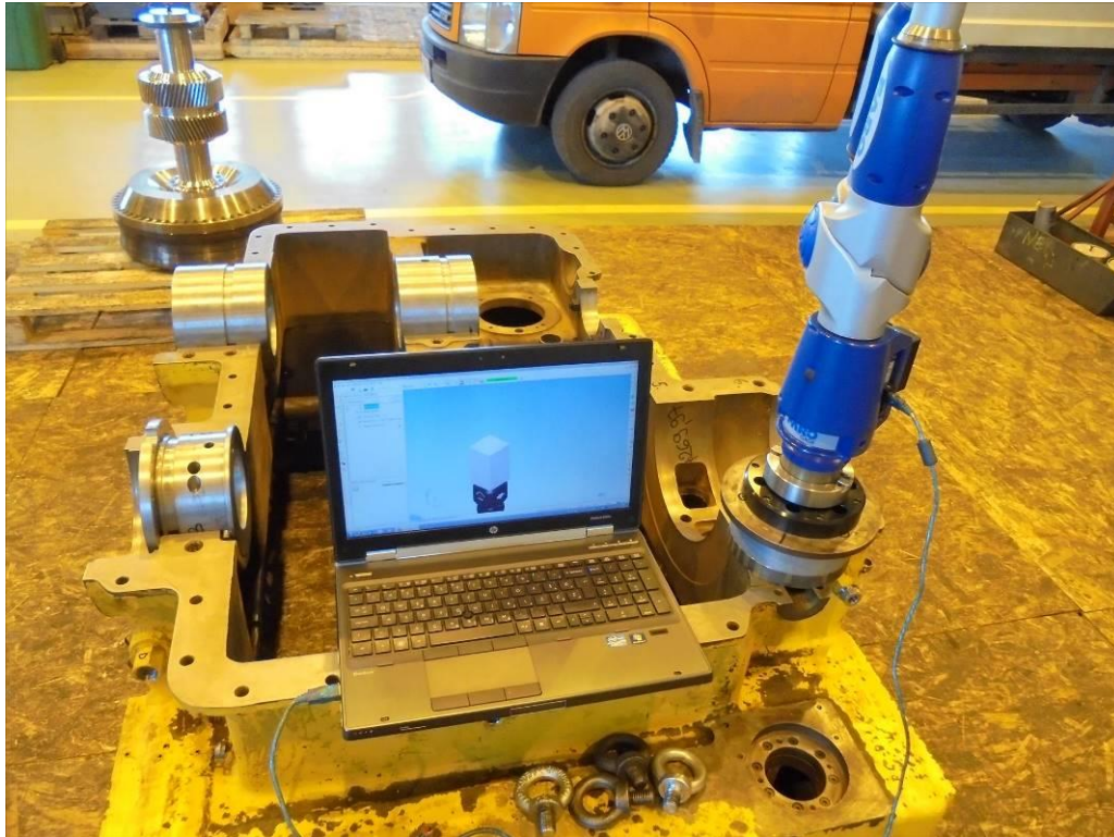
Slika 78. 3D mjerna ruka prije početka kontrole ležajnih dosjeda
