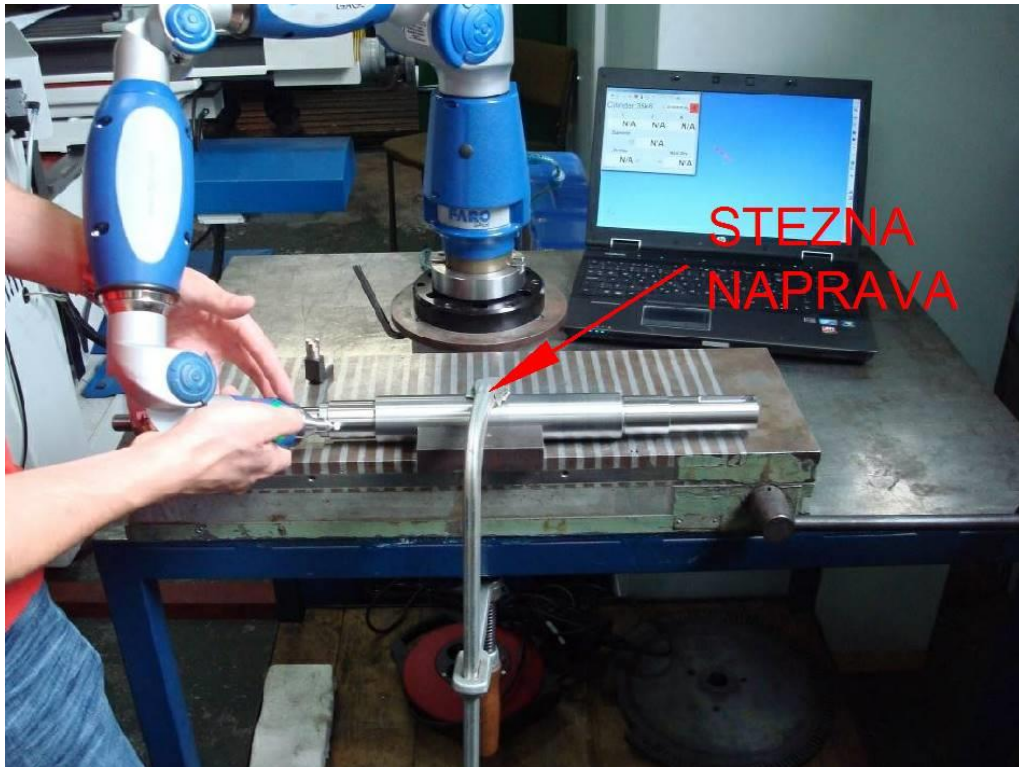
Slika 68. Dimenzionalna kontrola promjera vratila
