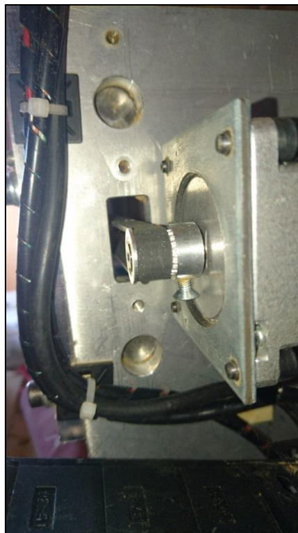
Slika 21: Remenski prijenos X os
