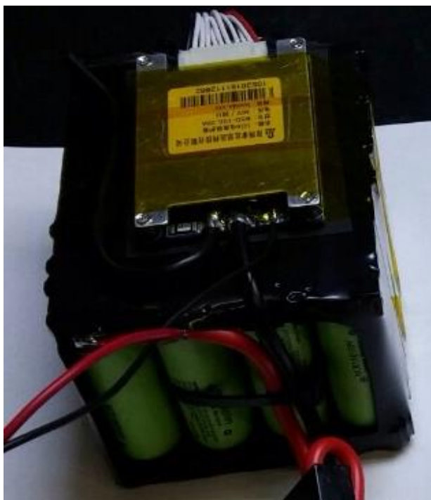
Slika 14. Bateriajski sklop sa BMS-om
