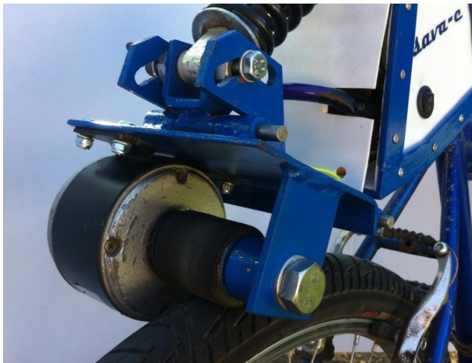
Slika 25. Tarni prijenos, realizirano
