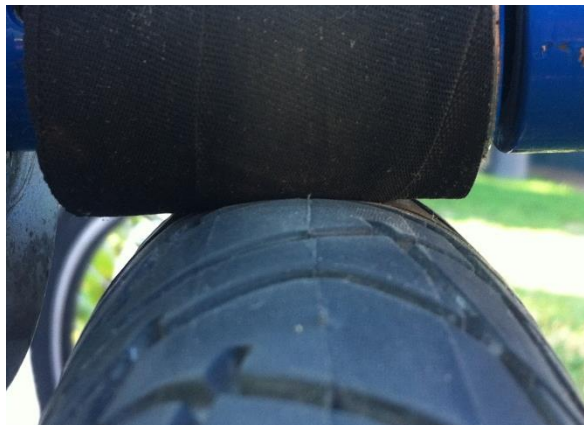
Slika 34. Deformacija radnih površina na mjestu dodira tareničkog para
