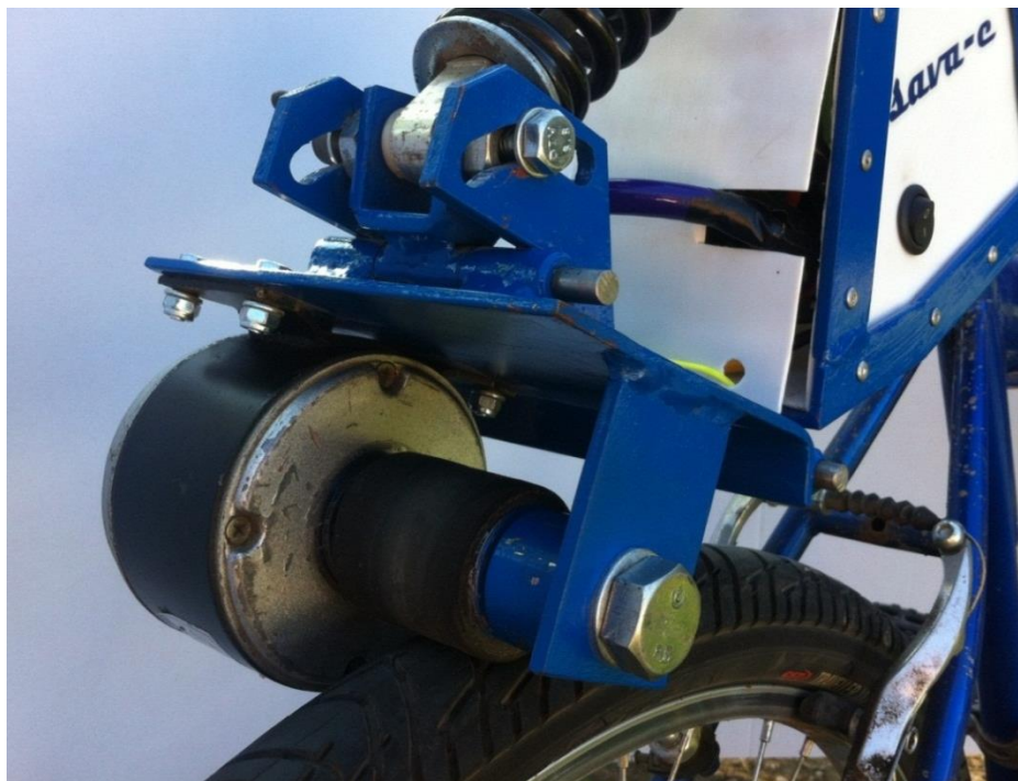
Slika 25. Tarni prijenos, realizirano
