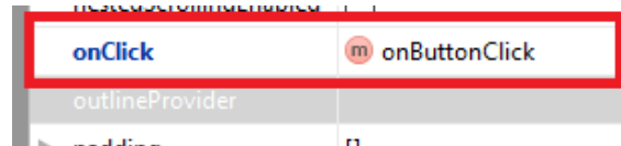
Slika 2.15. Predodžba podešavanja svojstva gumba za izvršenje funkcije prilikom pritiska
