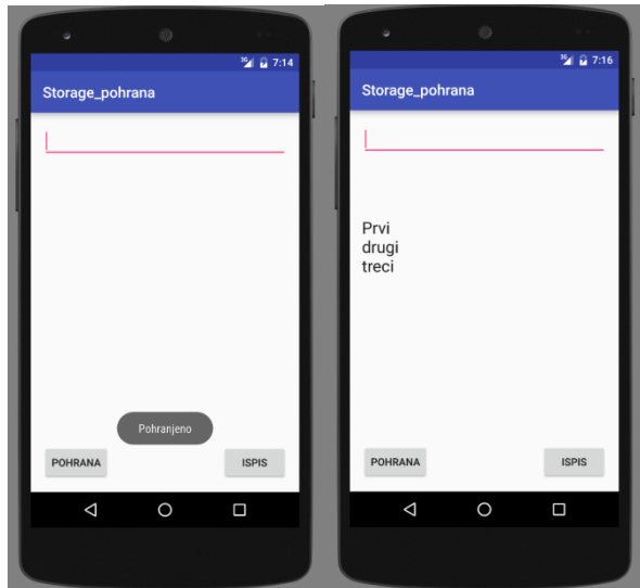
Slika 3.59. Predodžba simulacije aplikacije u emulatoru na računalu. Prva slika prikazuje zaslon prilikom pritiska gumba „POHRANA“, a druga slika prikazuje zaslon nakon pritiska gumba „ISPIS“. Pohranjen tekst je ispisan.
