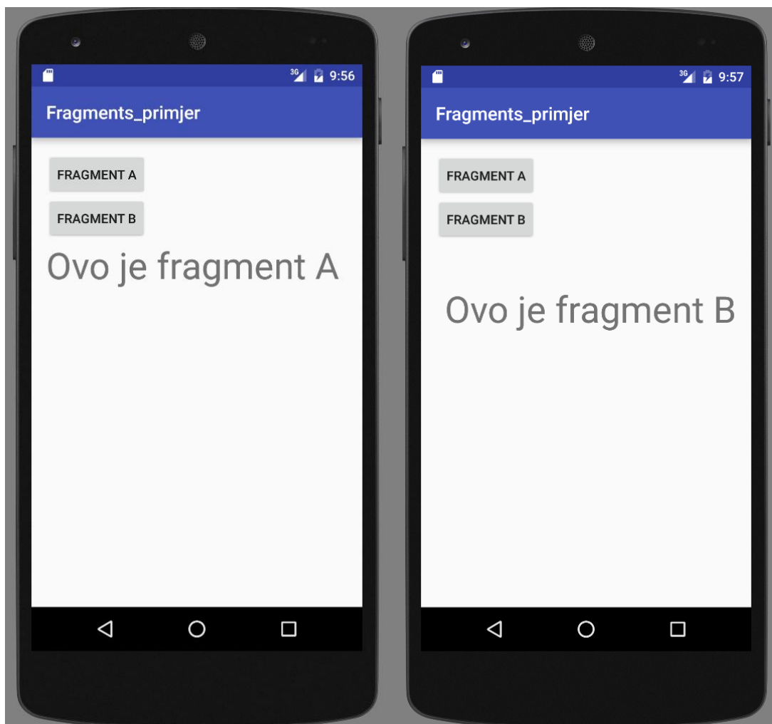
Slika 3.41. Predodžba simulacije aplikacije u emulatoru na računalu. Prva slika je ono što se prikaže pritiskom na gumb A, a druga za gumb B. Tekst koji se pojavi je dio aktivnog fragmenta
