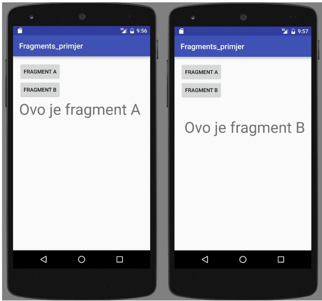
Slika 3.41. Predodžba simulacije aplikacije u emulatoru na računalu. Prva slika je ono što se prikaze pritiskom na gumb A, a druga za gumb B. Tekst koji se pojavi je dio aktivnog fragmenta
