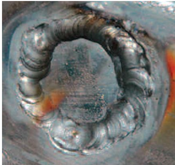
Slika br.13. Primjer ispunjavanja rupe zavarom
