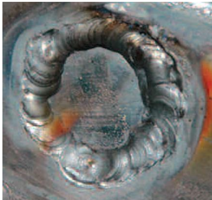
Slika br.13. Primjer ispunjavanja rupe zavarom
