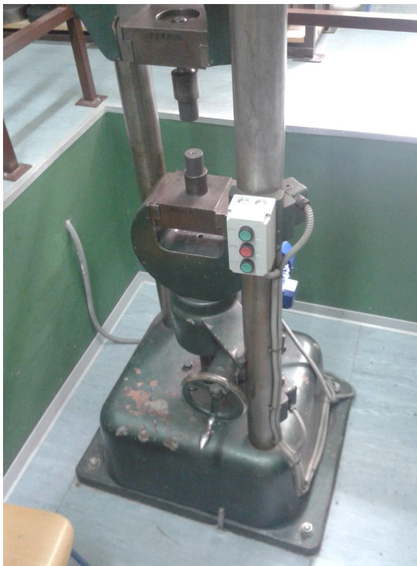
Slika 17. Kidalica Otto Wolpert Werke
