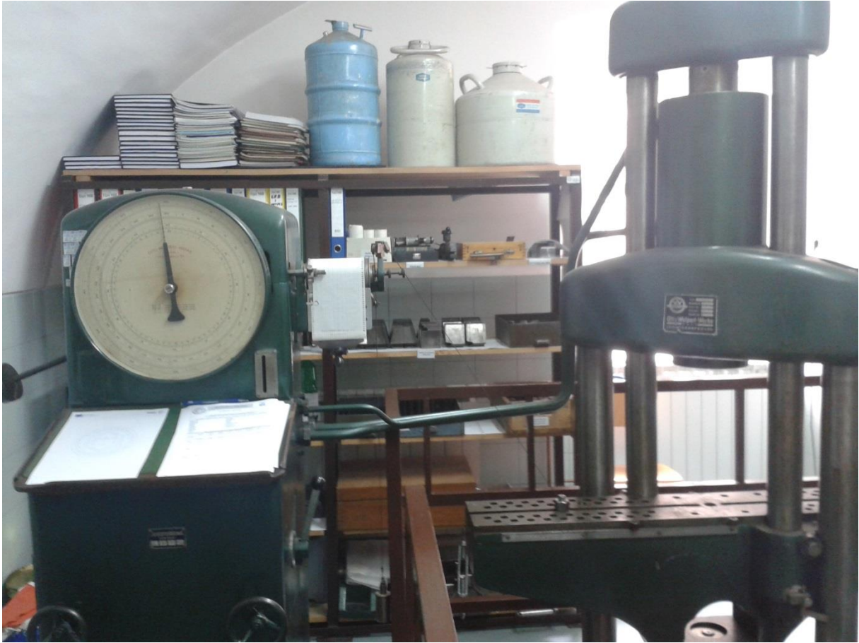
Slika 18. Kidalica Otto Wolpert Werke
