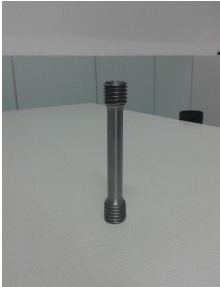
Slika 15. Epruveta s ispitivanja (prije loma)
