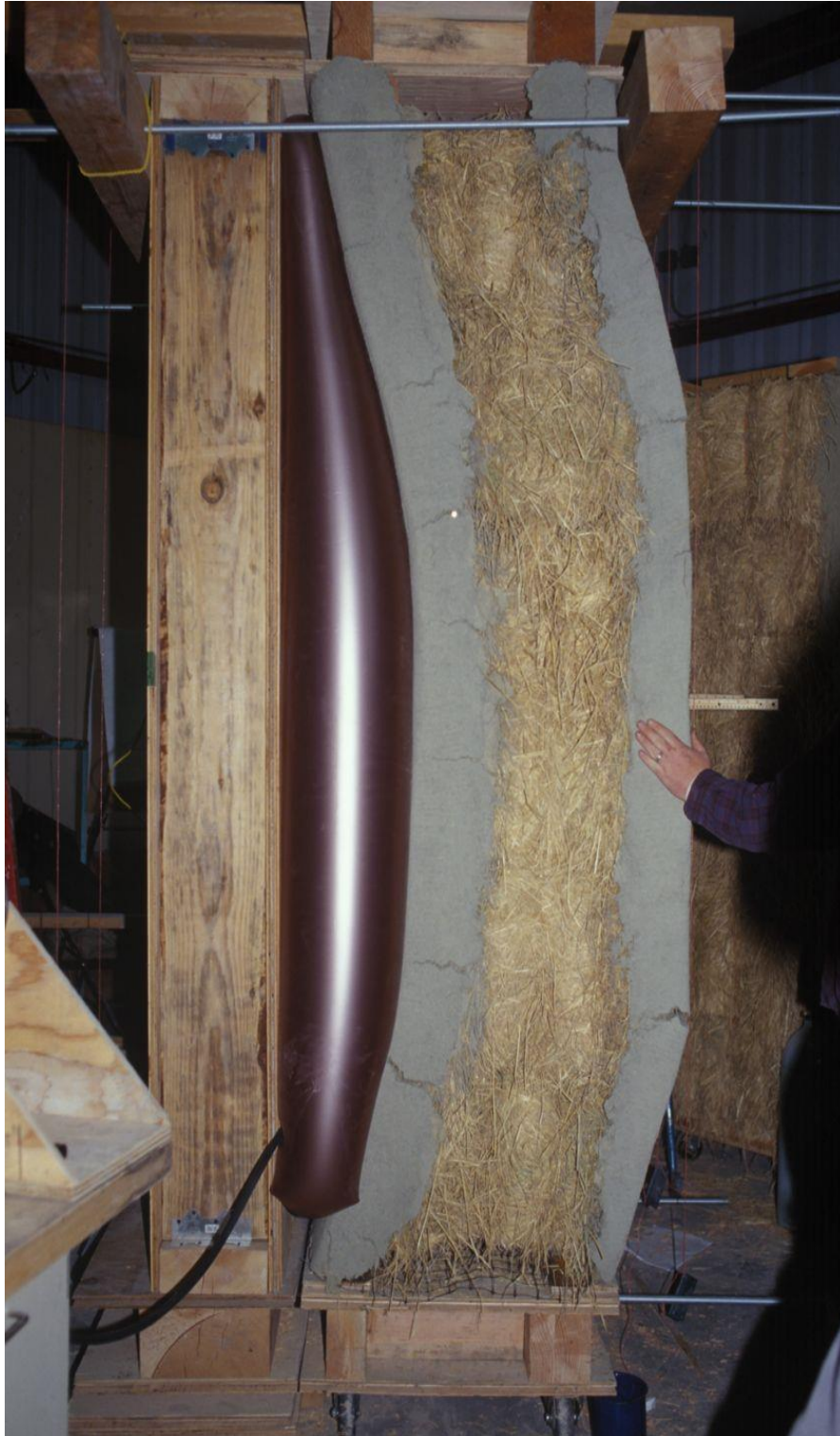
Sl. 8. Test izdržljivosti i pritiska bale slame [9]
