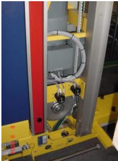
Slika 13. Pogon Miniload dizalice
