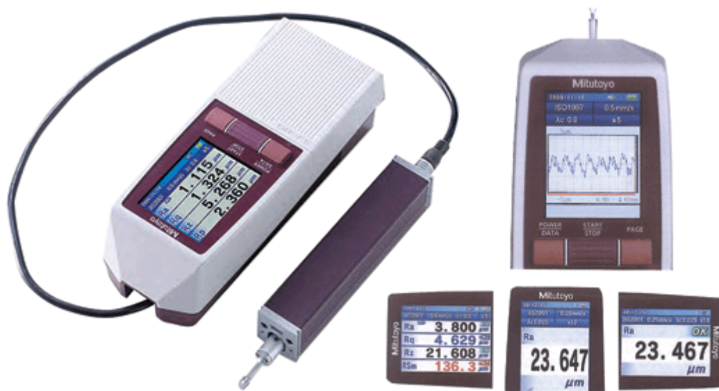
Slika 27. Uređaj za mjerenje hrapavosti Mitutoyo sj-210 [26]
