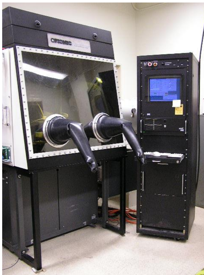
Slika 20. Stroj za izradu predmeta LENS postupkom [20]
