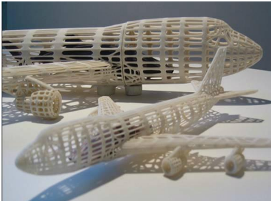
Slika 16. Primjer modela izrađenih na SLS pisaču [16]
