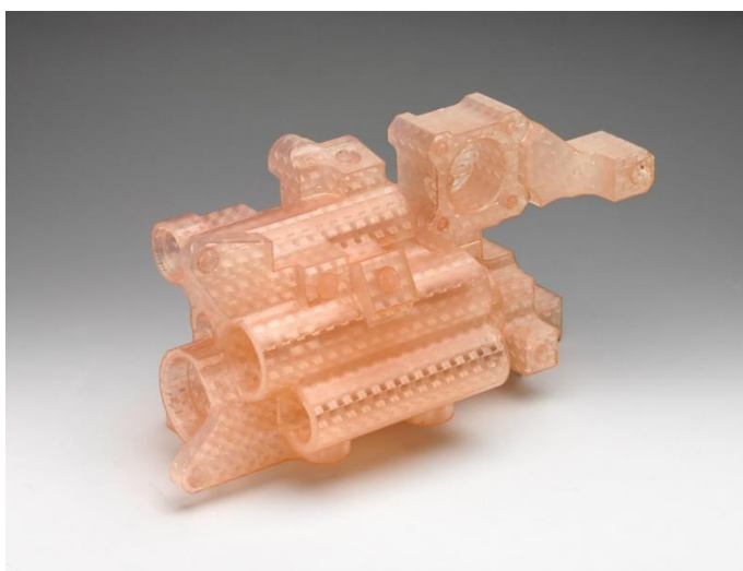
Slika 5. Primjer modela izrađenog stereolitografskim postupkom [5]
