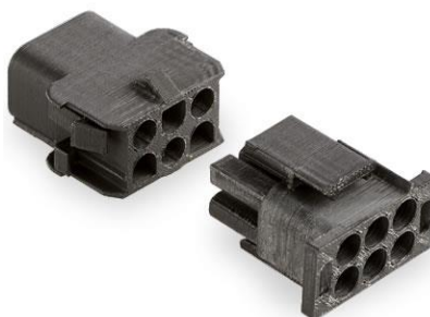
Slika 10. Primjer izrađenih modela FDM postupkom [10]
