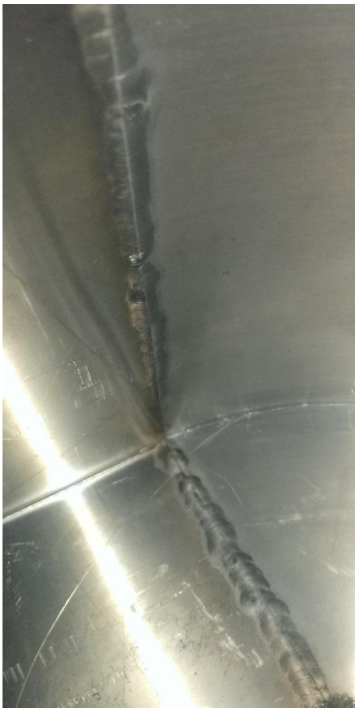
Slika 43. Potpuna penetracija MIG postupkom
