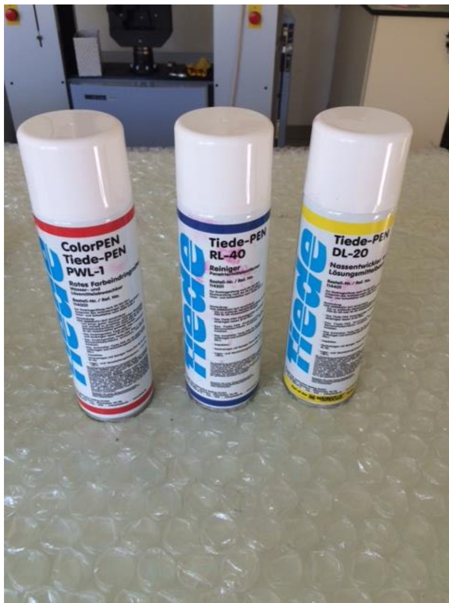
Slika 35. Penetranti za ispitivanje
