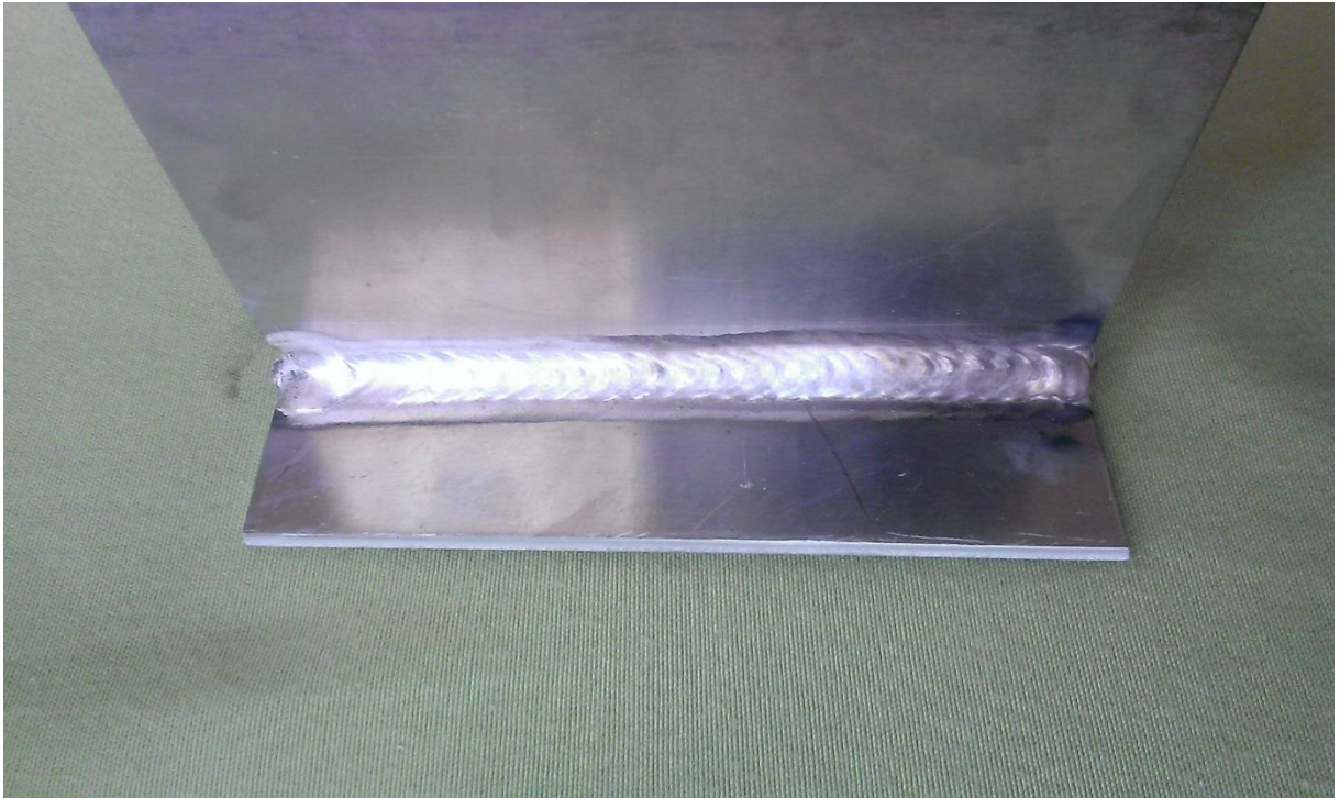
Slika 28. Ispravni kutni zavar MIG postupkom
