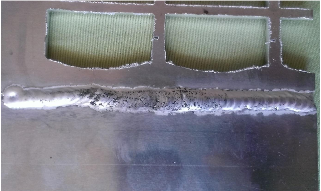
Slika 30. Crne mrlje: Izlučivanje vodika na površinu zavara
