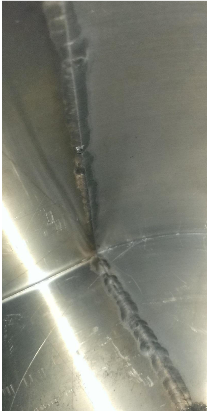
Slika 43. Potpuna penetracija MIG postupkom
