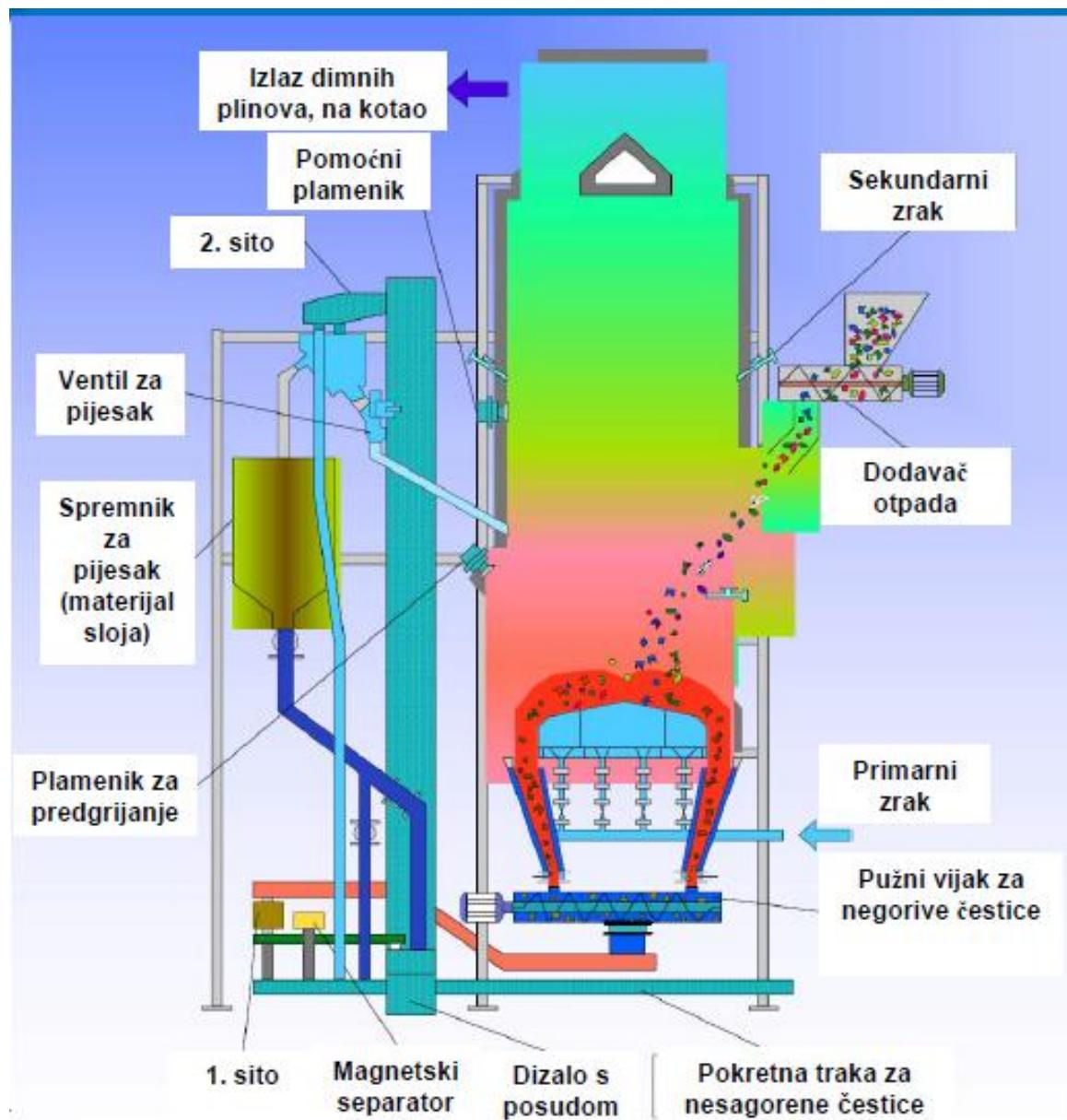
**Slika 9. Spaljivač s vrtložnim fluidiziranim slojem [19]**
