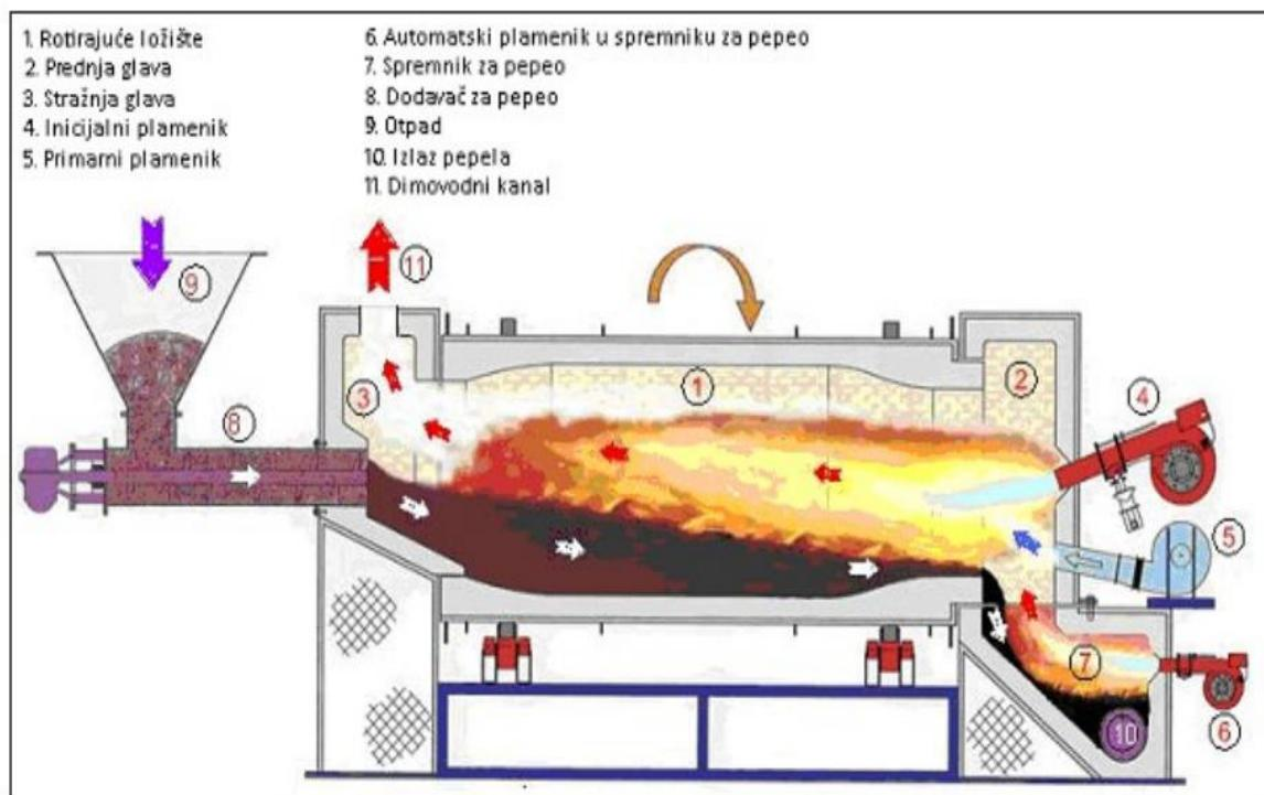
Slika 10. Rotacijska peć [20]
