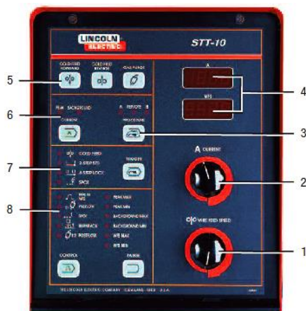
Slika 25. Upravljanje dodavačem žice za zavarivanje; LINCOLN ELECTRIC INVERTEC STT 10 [8]
