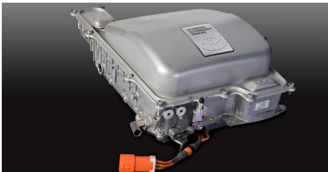
Slika 16. Inverter/konverter Toyota Prius [11]
