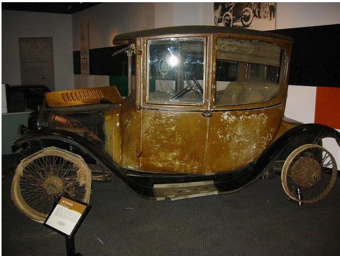
Slika 2. Hibridni automobil Henri-Pieper [2]
