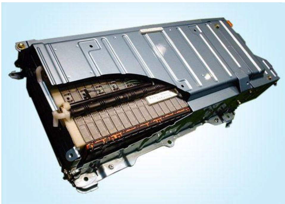
Slika 18. Li-ion (Litij ionska) baterija Toyota Prius [12]
