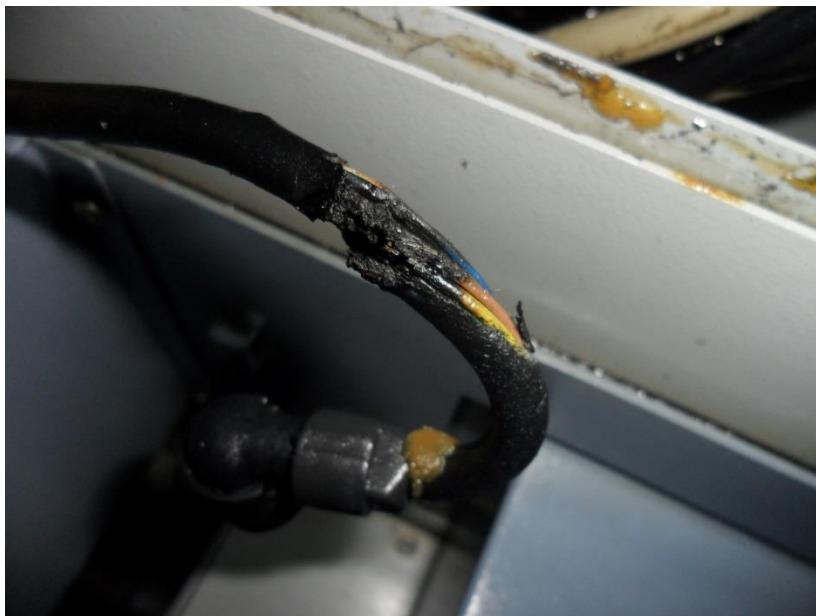
Slika 16: Oštećenje kablova na pregibnim dijelovima
