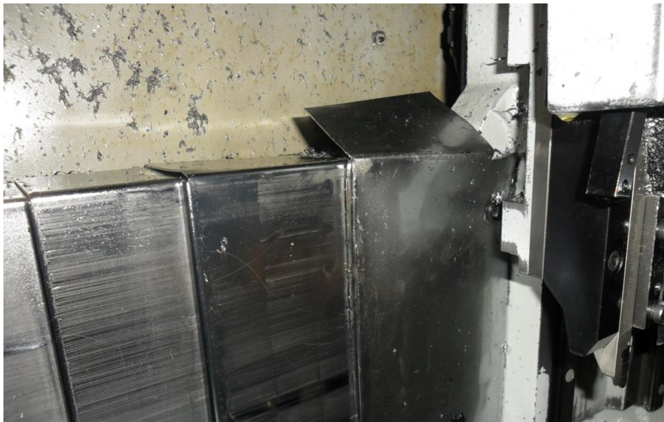
Slika 18: Oštećenje dijela stroja uslijed rada zbog strugotine
