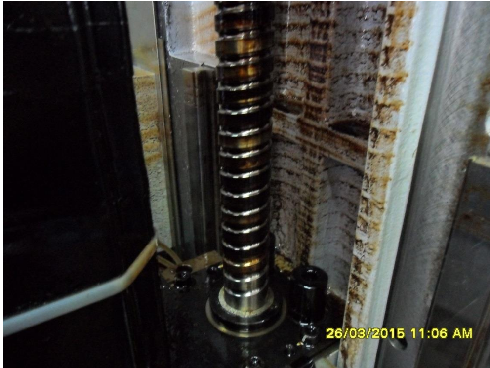
Slika 22: Oštećeno kuglično navojno vreteno
