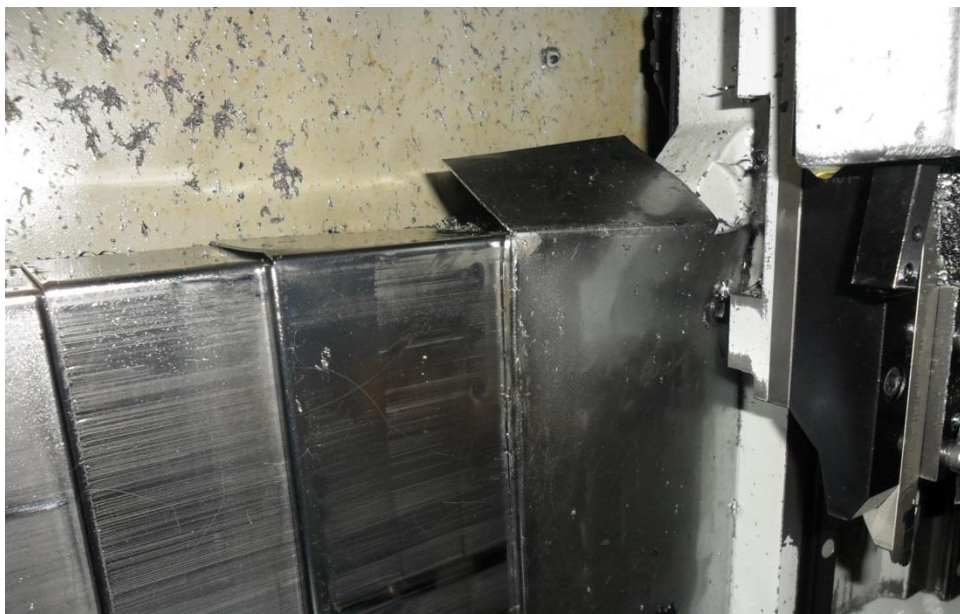
Slika 18: Oštećenje dijela stroja uslijed rada zbog strugotine
