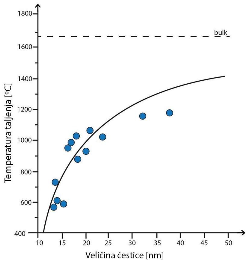
Slika 23 Temperatura taljenja kadmijevog sulfida
