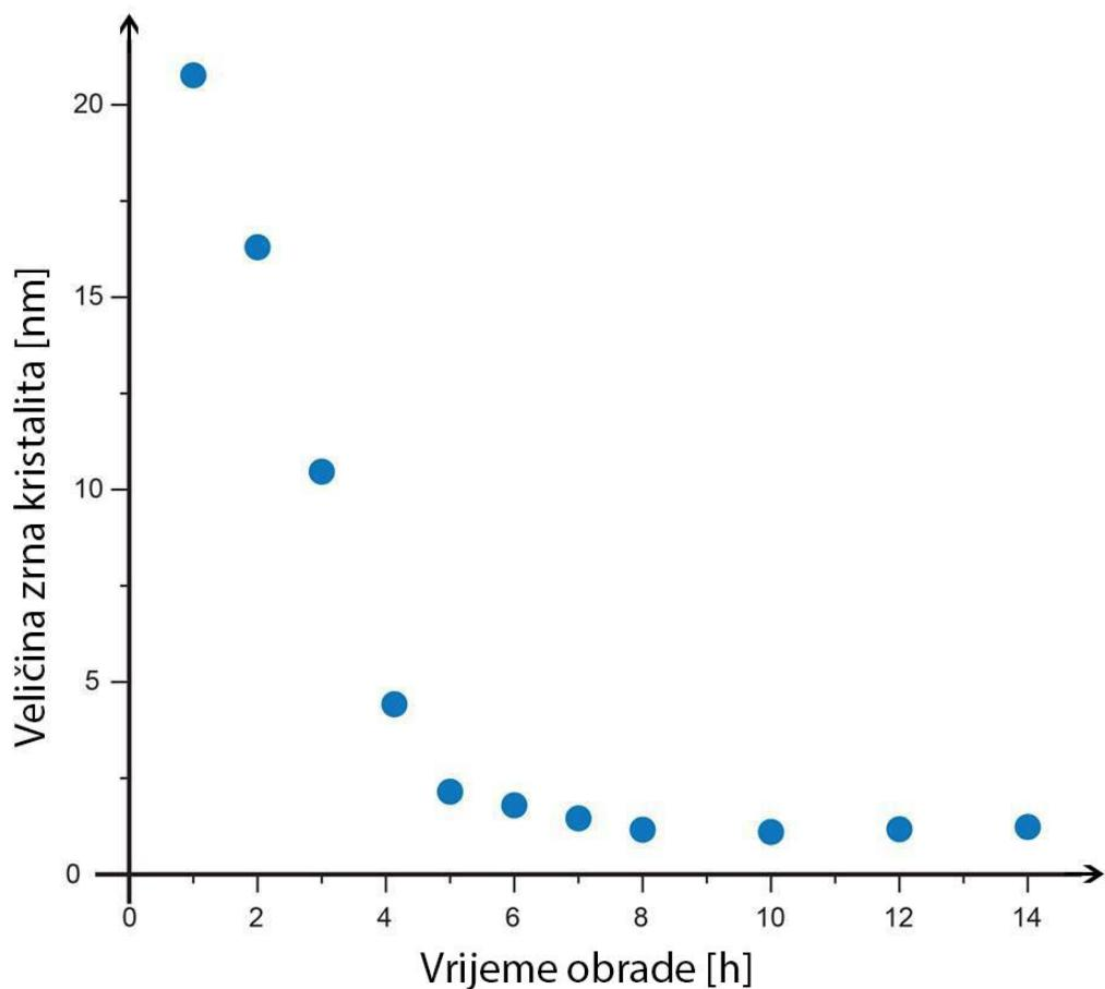
Slika 15 Mljevenje elementarnih prahova smjese Ni-Nb
