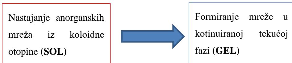
Koloidna otopina kojom se radi postupak geliranja sastoje se od veoma sitnih čestica, koje imaju promjer od 1 [nm] do 1 [ $\mu\text{m}$ ], a jednoliko su suspendirane po koloidnoj suspenziji tekućine u krutini koju predstavlja gel. Za takav postupak najboljim prekursorima<sup>4</sup> pokazali su se metalni alkoksidi jer brzo reagiraju s vodom.
