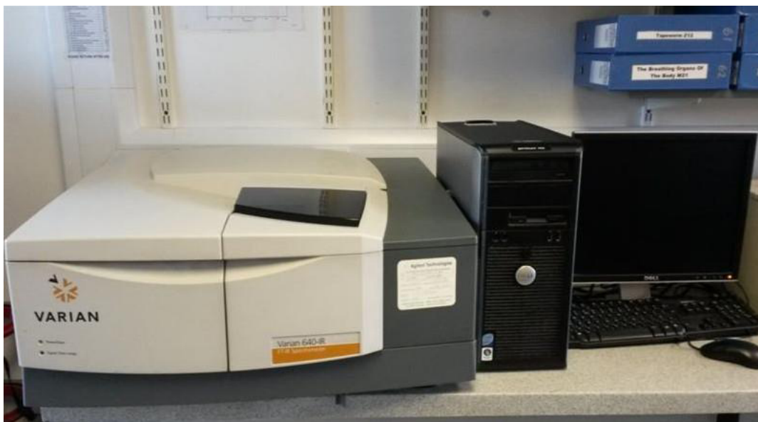
Slika 11. FT-IR analizator ulja, model 640 (Varian)
