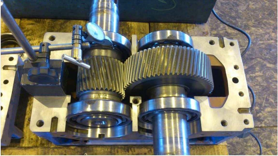
Fotografija 4.1 Defektaža reduktora
