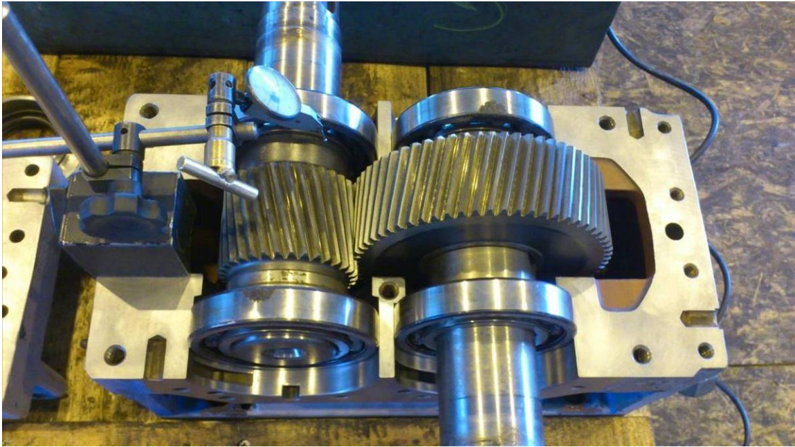
Fotografija 4.1 Defektaža reduktora
