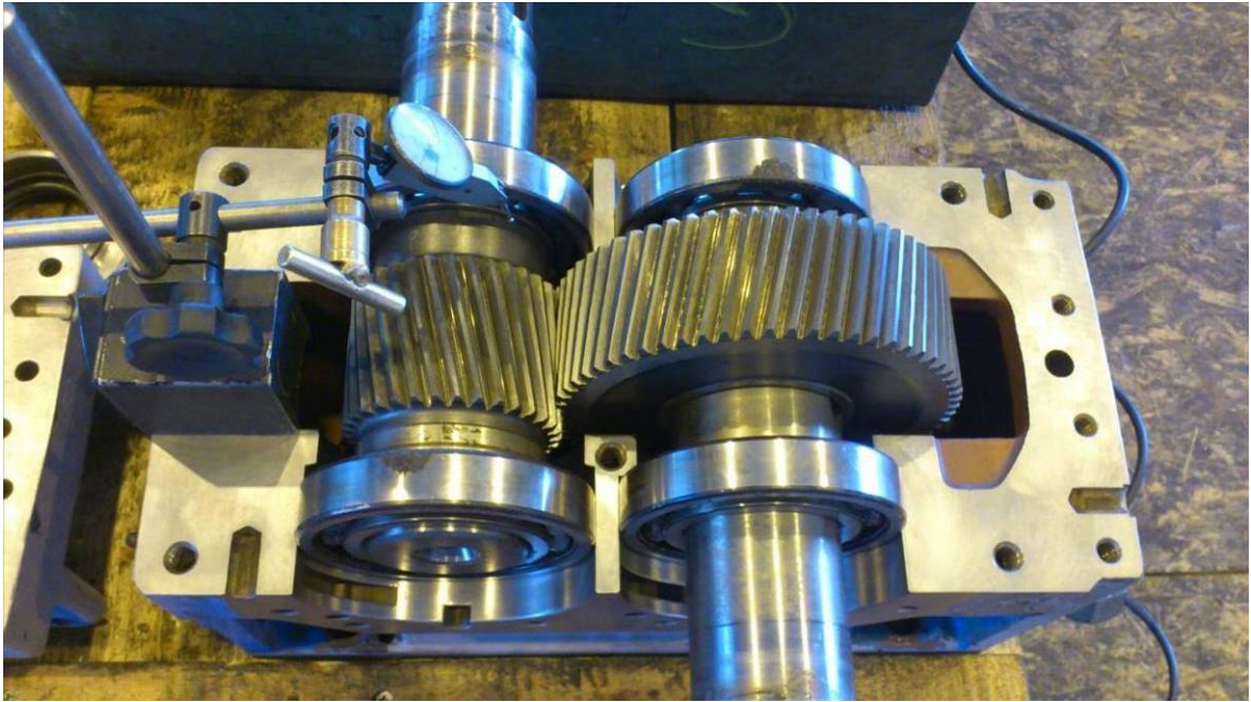
Fotografija 4.1 Defektaža reduktora
