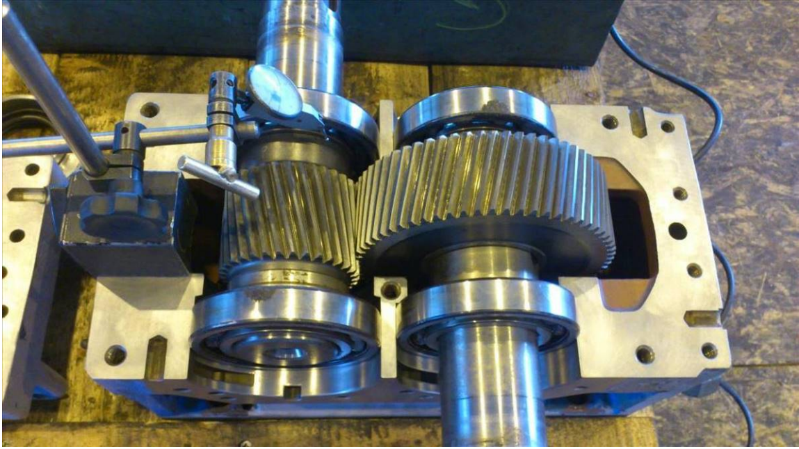
Fotografija 4.1 Defektaža reduktora
