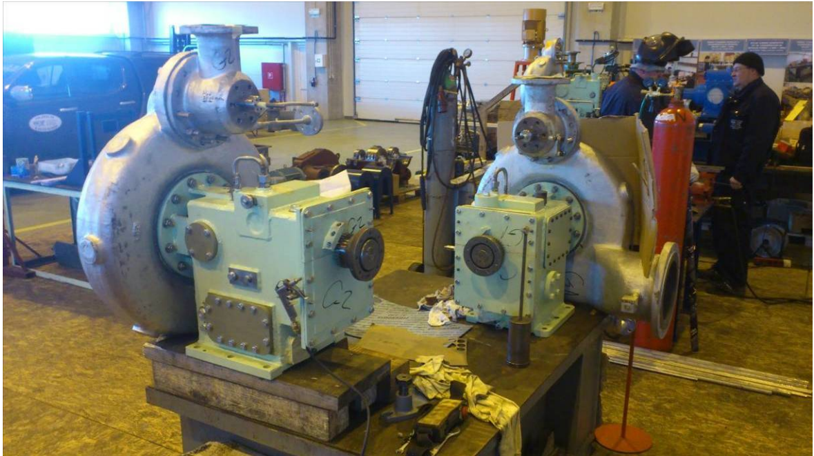
Fotografija 4.3 Podmontaža turbine
