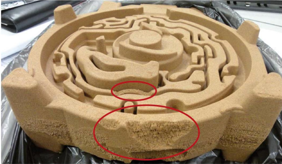
Slika 41. Prikaz jezgre poklopca kućišta mjenjača sa greškama.
