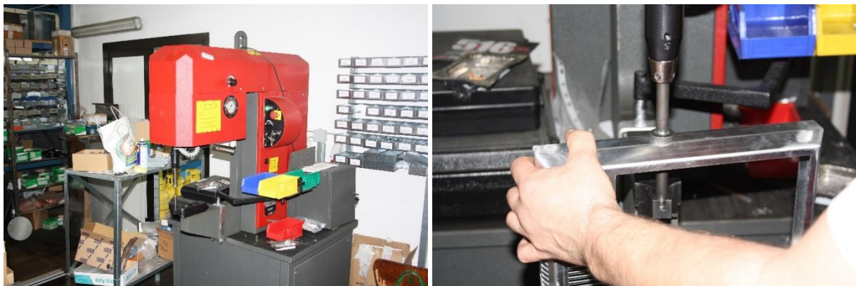
Slika 33 Utiskivanje matice u kućište
