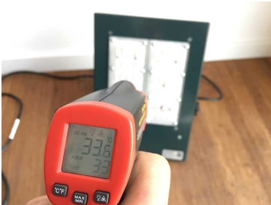
Slika 36 Mjerenje temperature kućišta
