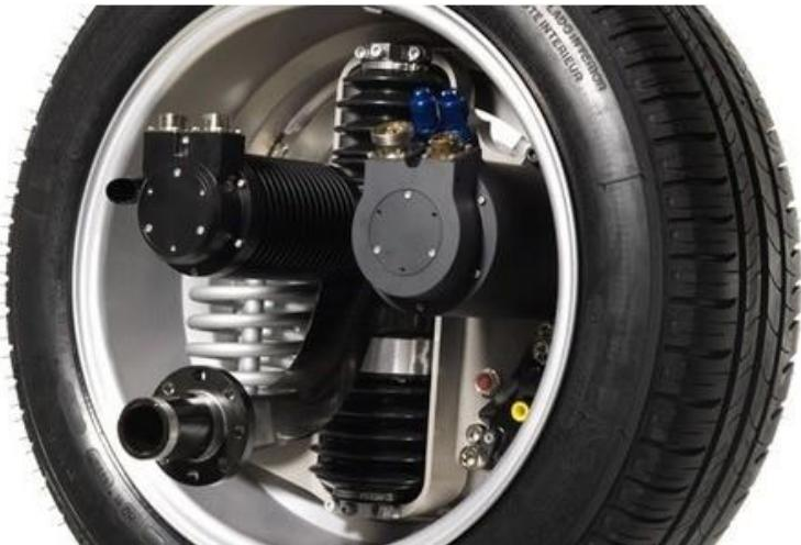
Slika 8. Sustav regenerativnog kočenja unutar kotača automobila
