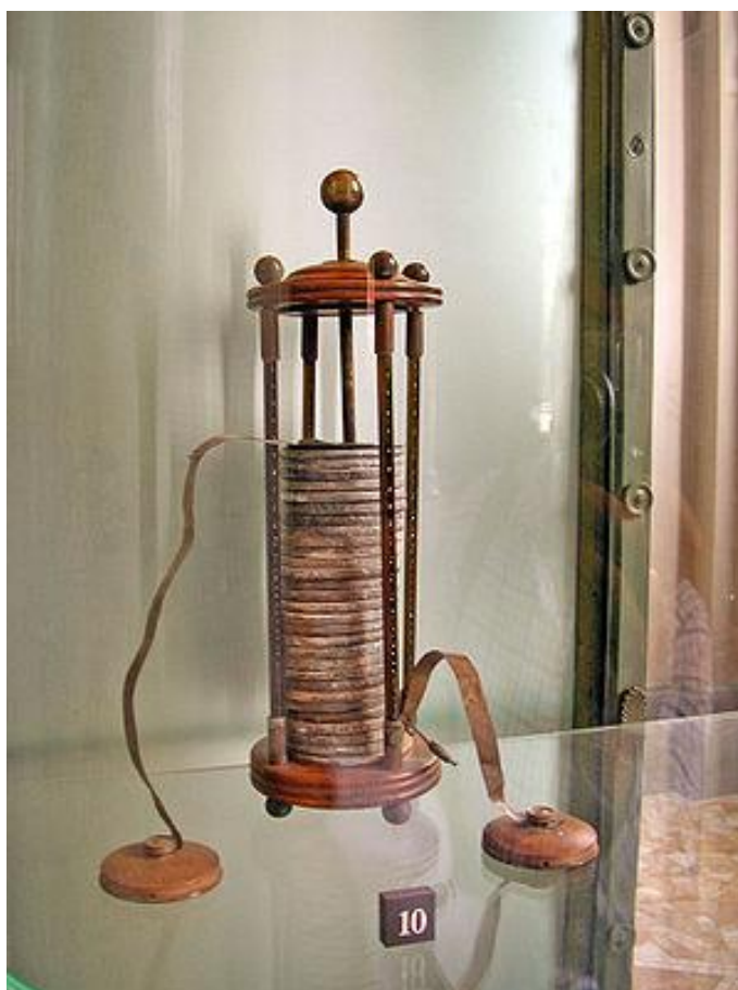
Slika 18. Voltin članak (izložbeni primjerak u muzeju)
