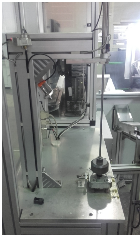
Slika 30. Prikaz mjerenja komada i kalibriranja mjernog trna
