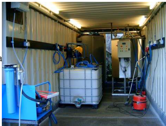
Slika 24: Malo postrojenje za proizvodnju biodizela
